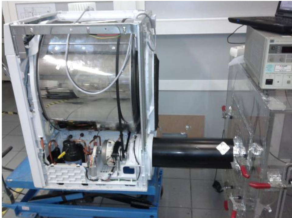
Şekil 4.11 : Çamaşır kurutma makinesinin rüzgar tüneline bağlanması.
