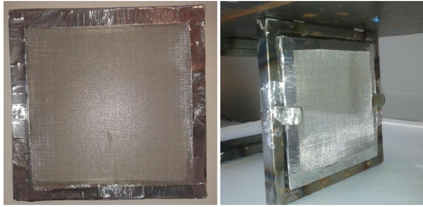
Şekil 4.1 : Filtrelerin deney düzeneği üzerine yerleştirilmesi.
