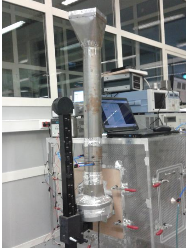
Şekil 3.8 : Deney düzeneğinin debi ölçümü için kalibrasyonu.
