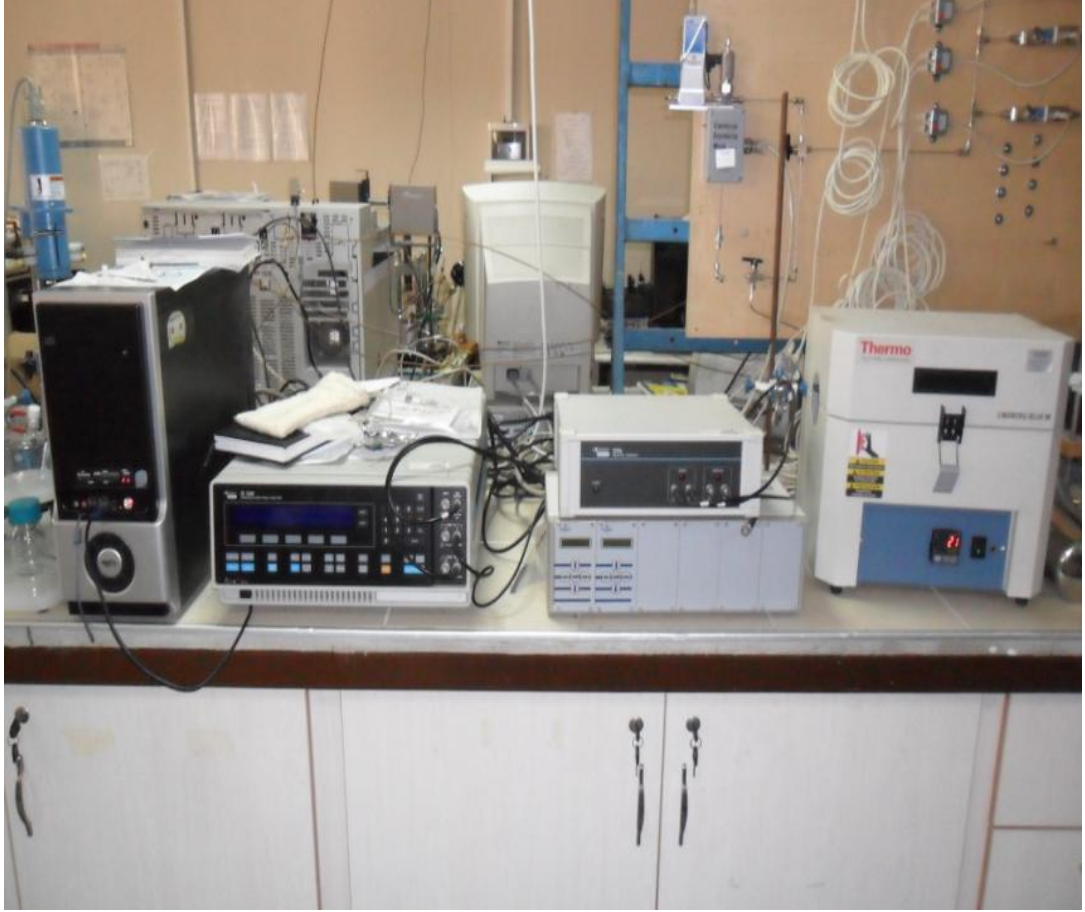
Şekil 5.3. İyonik iletkenlik ölçüm sistemi
