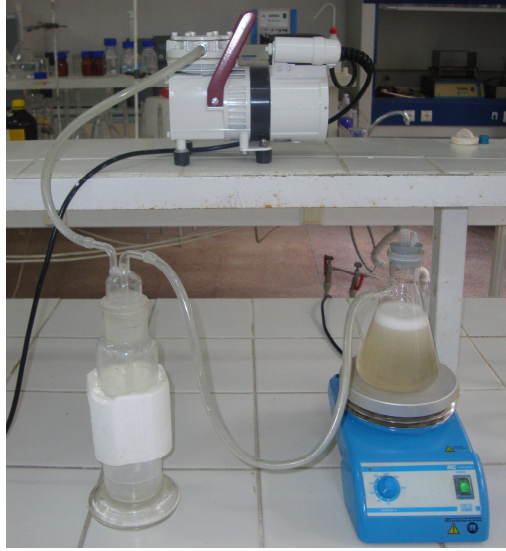
Şekil 3.2. Kaplama solüsyonundaki hava kabarcıklarının uzaklaştırılması
