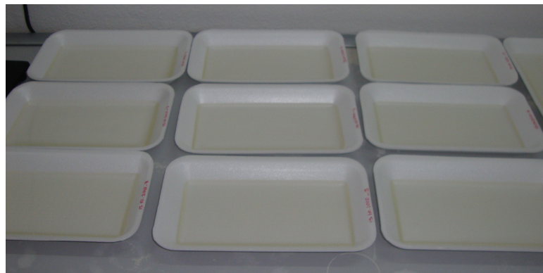
Şekil 3.3. Kaplama solüsyonunun strafor tabaklara dökülmesi
