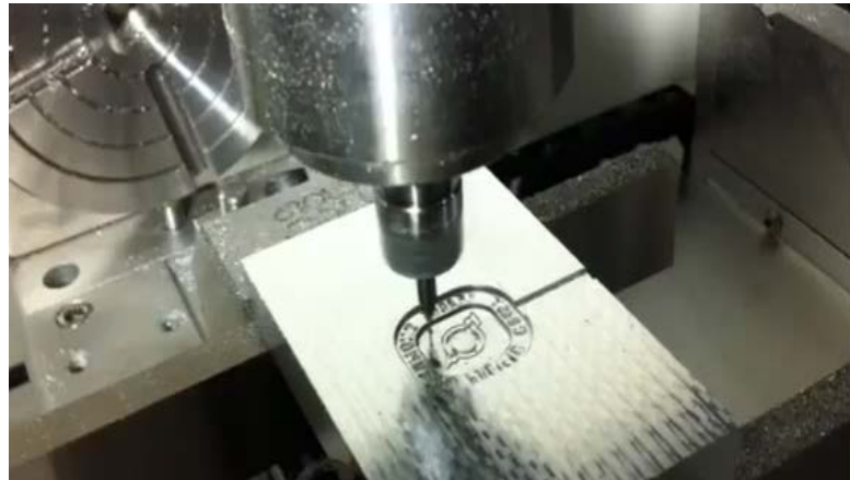
Fotoğraf 6: Cnc de enjeksiyon kalıbının işlenmesi (Metal diecutting a texture,2012).
