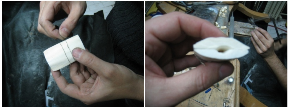
Fotoğraf 65: Kalıbı sabitlemek için tel ile bağlama işlemi.
