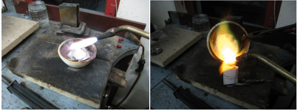
Fotoğraf 66: Gümüşün bir potada eritilmesi ve dökülmesi.
