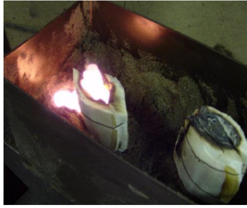
Fotoğraf 41: Kalıp sabitlendikten sonra eritilen gümüş önceden hazırlanan yolluktan dökülür ve soğumaya bırakılır (Cuttlefish Bone Casting, 2012).
