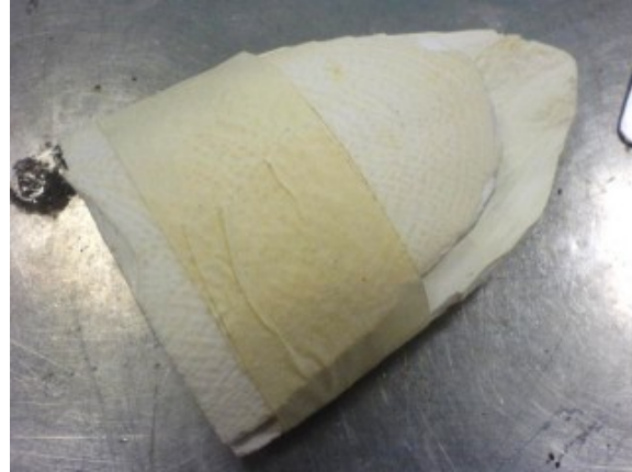
Fotoğraf 39: Alt ve üst kalıbın sabitlenmesi için bant yada bir tel yardımı ile sabitlenme işlemi (Cuttlefish Bone Casting, 2012).
