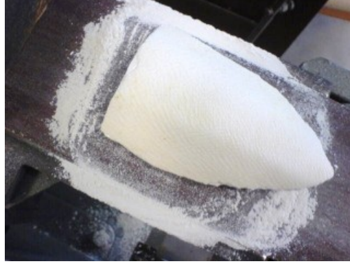
Fotoğraf 34: Model kalıba işlenmeden önce kemiğin yumuşak yüzeyi zımparalanarak düz bir hale getirilir (Cuttlefish Bone Casting, 2012).
