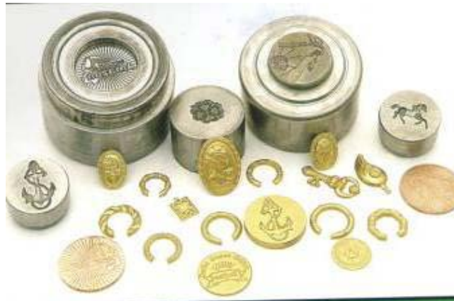
Fotoğraf 30: Baskı kalıpları (Megep,2011:16).
