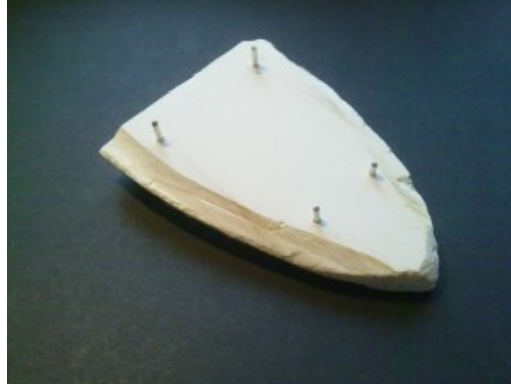
Fotoğraf 35: Mürekkep balığı kemiğinin üst ve alta gelecek yüzeylerine pimler yerleştirilerek iki kalıbın üst üste gelmesi sağlanır (Cuttlefish Bone Casting, 2012) .
