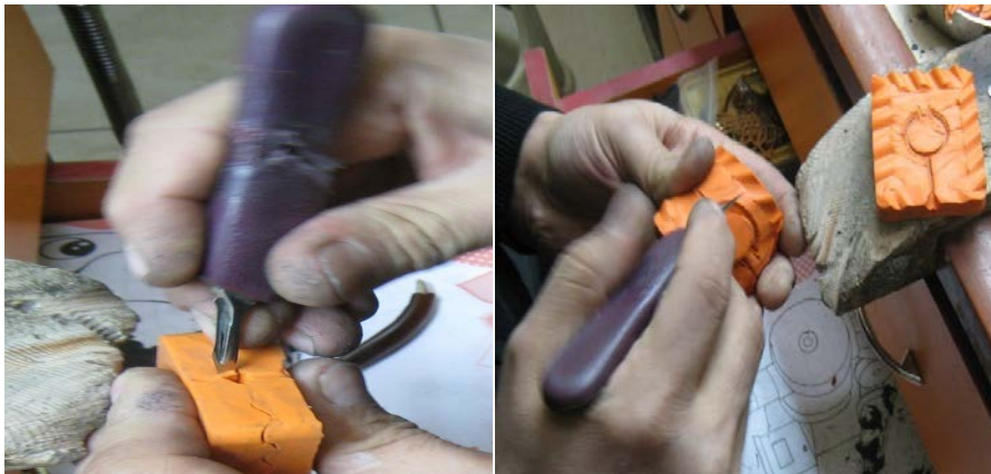
Fotoğraf 59: Mum basımında kullanılacak yolluğun ve genel olarak kalıbın son rötuşlarının yapılması.
