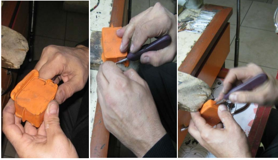
Fotoğraf 55: Neşter yardımıyla kauçuğun fazlalıklarının alınması ve yolluktan başlayarak zikzak şeklinde kesilme aşaması.
