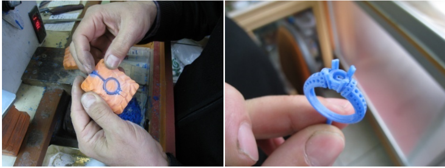
Fotoğraf 61: Mumun kalıba basılmış hali ve mum modelin kauçuk kalıptan çıkarılması.
