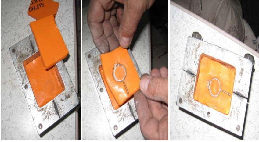
Fotoğraf 48: Yüzüğün kauçuğa yerleştirilmesi işlemleri.
