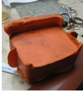
Fotoğraf 54: Kalıptan ve üzerindeki metallere ayrılmış kauçuk model.
