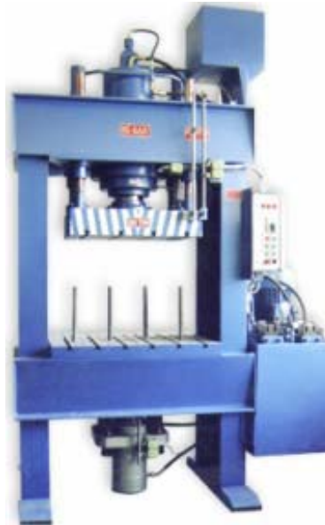
ğraf 24: Çift etkili hidrolik pres ( Özkan Hidrolik,2012) .
