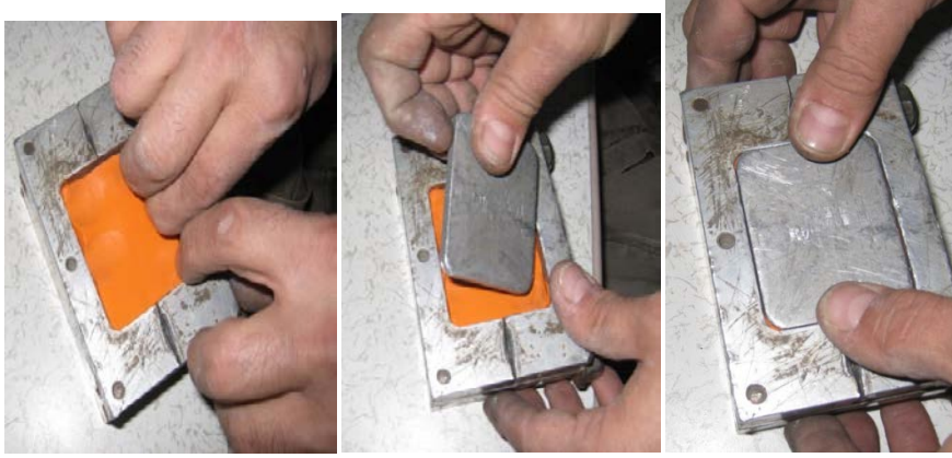
Fotoğraf 49: Yerleştirilen yüzüğün üstünün kauçuk ile kaplanması işlemi.
