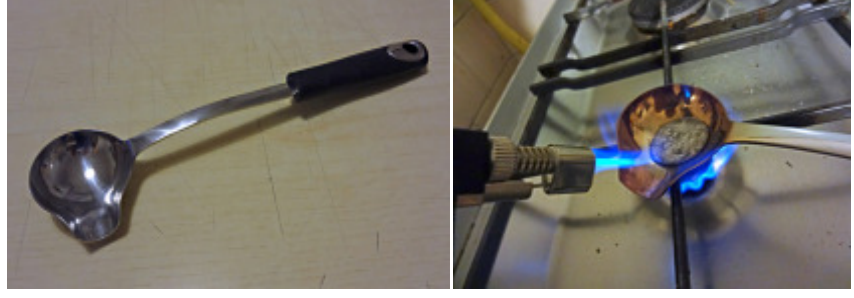
Fotoğraf 40: Hurda gümüşlerin potada eritilmesi işlemi. Hurda gümüşler potaya konularak eritilir (Cuttlefish Bone Casting, 2012).
