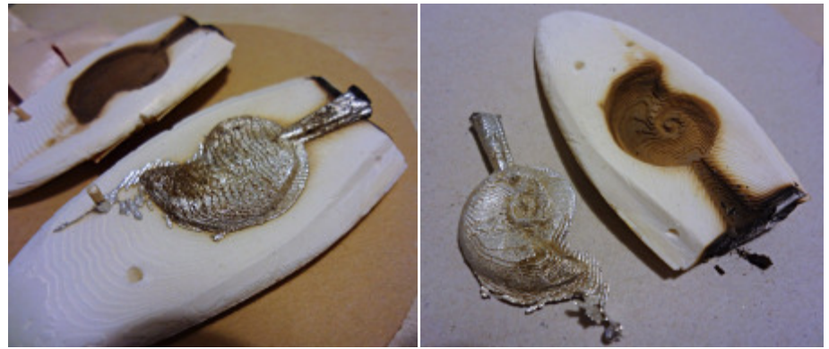
Fotoğraf 42: Kalıbın açılması, modelin çıkarılma işlemleri (Cuttlefish Bone Casting, 2012).
