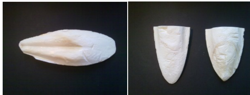
Fotoğraf 33: Kalıba alma işleminde kullanılacak mürekkep balığı kemiği (Cuttlefish Bone Casting, 2012) .
