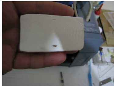
Fotoğraf 62: Sübye kalıp için kullanılan mürekkep balığı kemiği.
