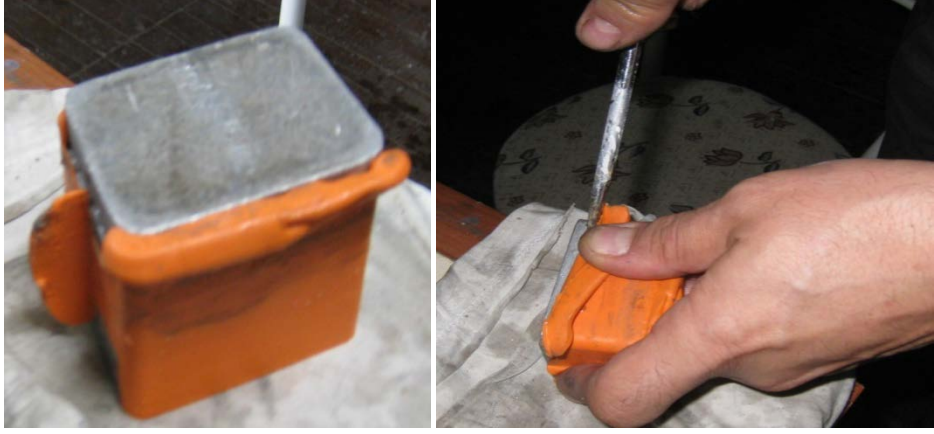
Fotoğraf 53: Kauçuğun üstüne yerleştirilen metalin çıkarılması.
