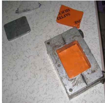
Fotoğraf 47: Kalıbın içine kauçuğun yerleştirilmesi işlemi.
