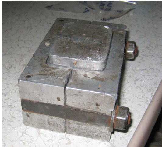
Fotoğraf 50: Pişirmeye hazır kauçuk kalıp.
