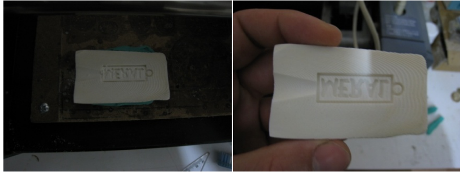
Fotoğraf 64: Cnc makinesinde modelin işlenmiş hali.
