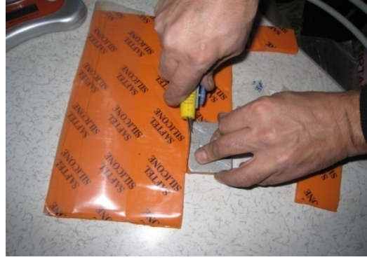
Fotoğraf 45: Kauçuk kalıp ölçüsünde kauçuğun kesilmesi.
