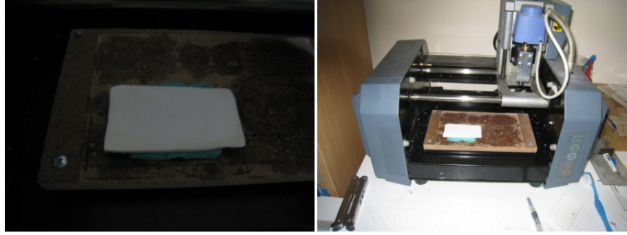
Fotoğraf 63: Mürekkep balığı kemiği modelin işlenmesi için cnc makinesine yerleştirilmesi ve modelin işlenmesi.
