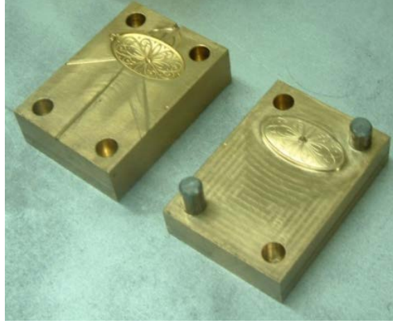
Fotoğraf 9: Dişi kalıptaki hava tahliye kanalları (Gümüş Kalıp, 2012).
