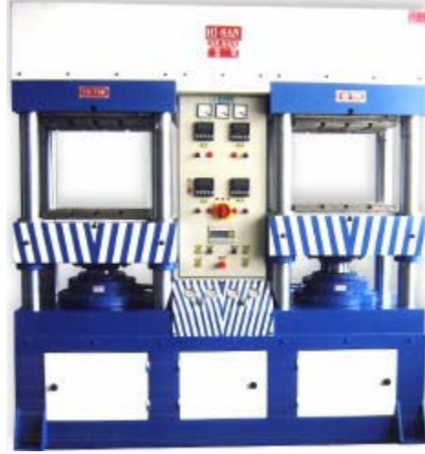
Fotoğraf 23: Tek etkili hidrolik pres ( Özkan Hidrolik,2012).
