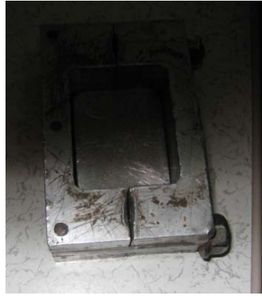
Fotoğraf 46: Kauçuk pişirme kalıbı.
