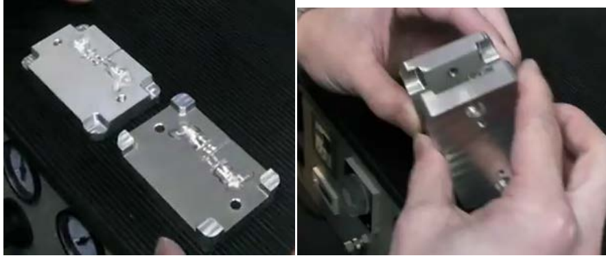
Fotoğraf 11: Kalıbın hareket etmeyecek şekilde birleştirilmesi işlemi (Neo PIM3500-1 PlasticInjector - Army Man Mold Project,2012).
