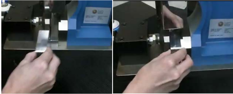
Fotoğraf 12: Kalıbın makineye yerleştirilmesi ve sıkıştırma pistonuyla sabitlenip basım yapılması işlemi (Neo PIM3500-1 PlasticInjector - Army Man Mold Project, 2012).
