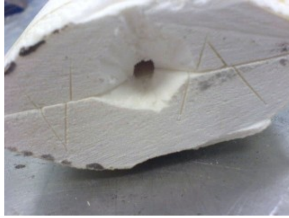
Fotoğraf 38: Döküm yaparken kullanılan yolun şekillendirilmesi işlemi (Cuttlefish Bone Casting, 2012).
