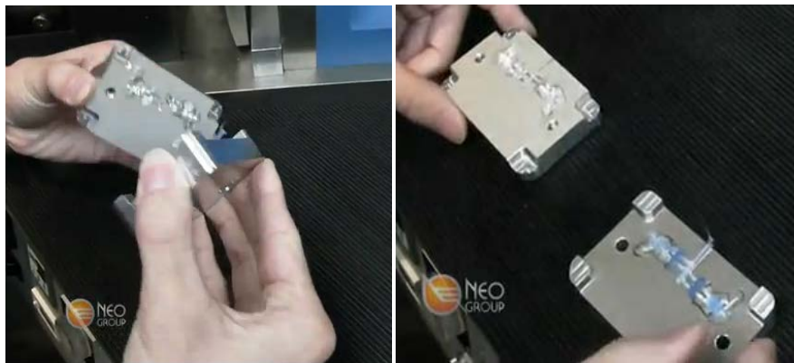
Fotoğraf 13: Kalıbın açılması işlemi. Plastik soğuması beklenilir, kalıp yavaşça açılır (Neo PIM3500-1 PlasticInjector - Army Man Mold Project, 2012).
