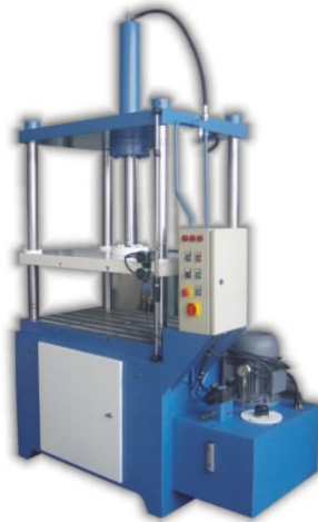
Fotoğraf 22: Hidrolik pres ( Özkan Hidrolik,2012) .
