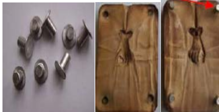
Fotoğraf 3: Merkezlemede kullanılan perçin ve kalıplanmış hali (Megep,2006:5).
