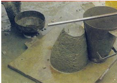
Şekil 4.18 : Şantiyede Kıvam deneyi yapılması [40].
