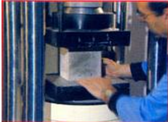
Şekil 4.20 : Beton k p numuneleri üzerinde basınç deneyinin yapılması [40].
