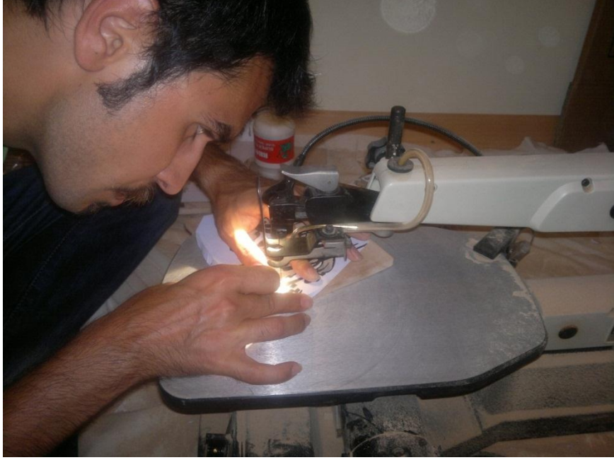
Şekil 41: Dekopaj Testeresi'ile Kalıp Oyma İşlemi
