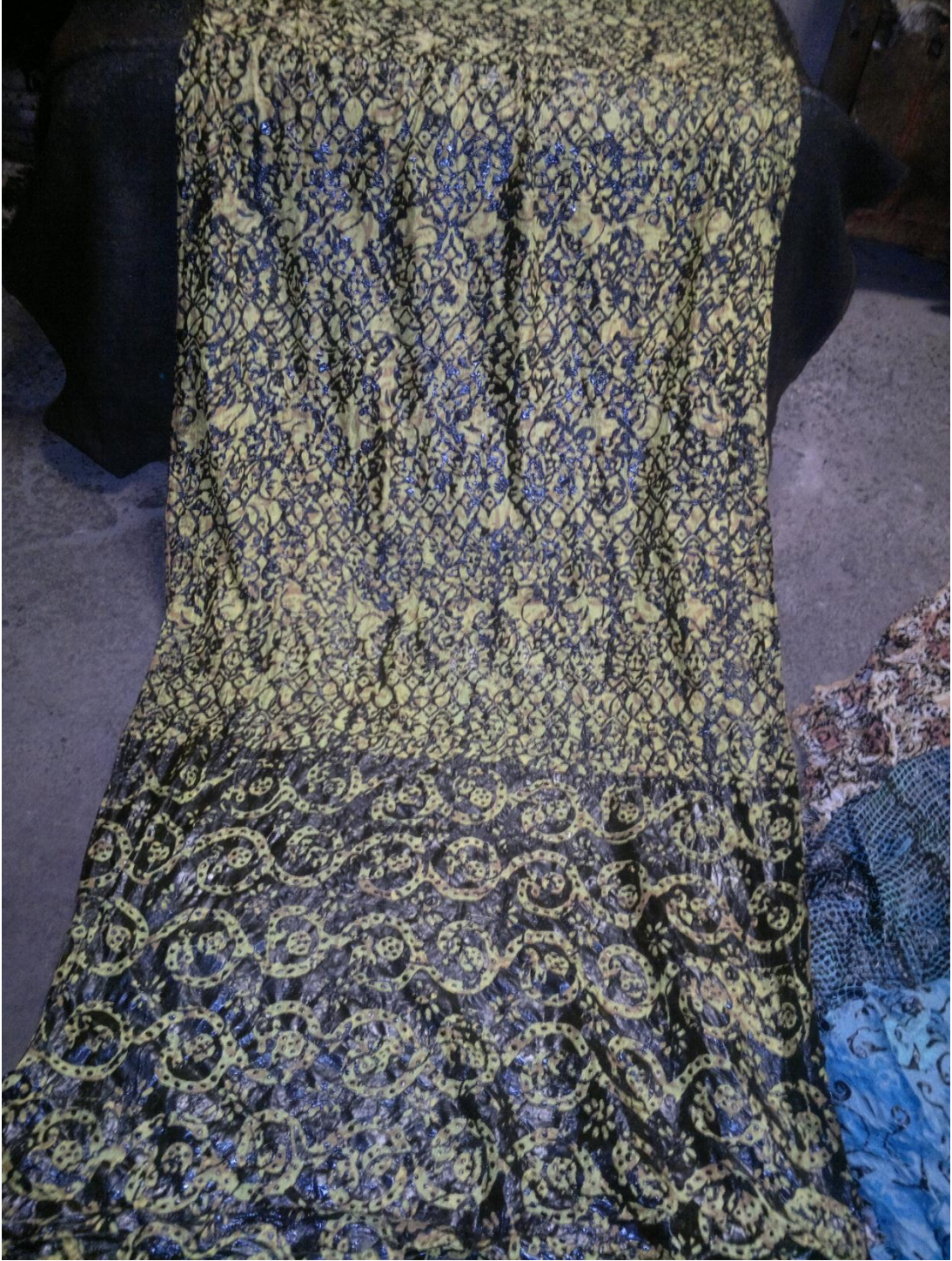
Şekil 46: Sarı Renge Boyanmış Kumaşın Rezervelemesi
