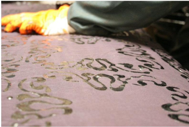
Şekil 45: Mor Rengin’de Boyanmış Kumaşın Rezervelemesi
