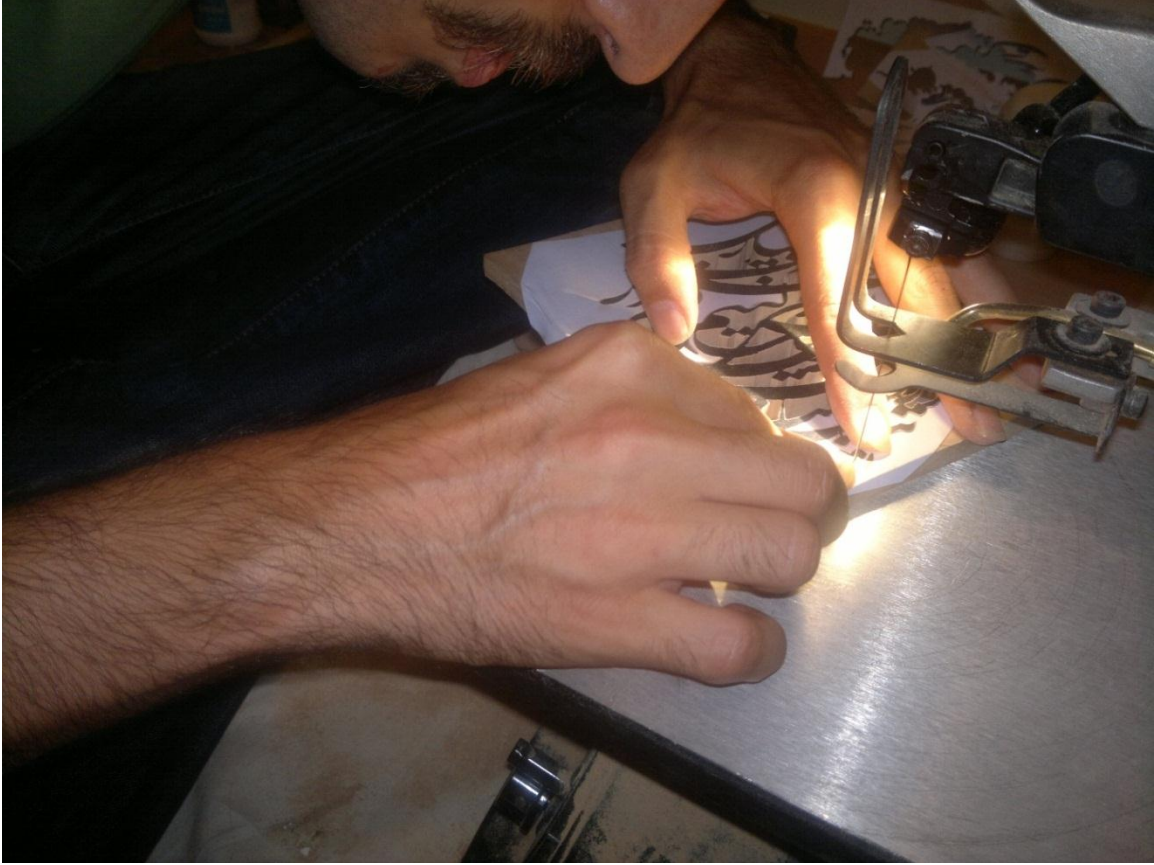
Şekil 38: Dekopaj Testeresi'ile Kalıp Oyma İşlemi
