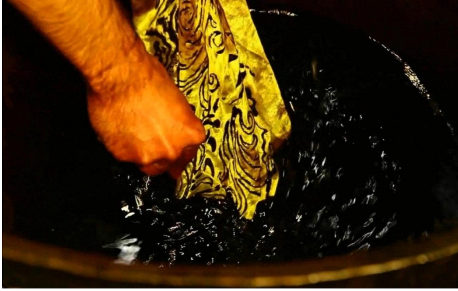
Şekil 29: Kumaşların Sıcak Petrol'de Sökülmesi
