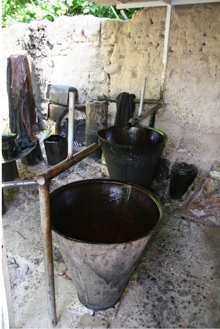
Şekil 25: Ali Akbarzadeh'nin Atölyesindeki Rezerve Söküm Kazanı
