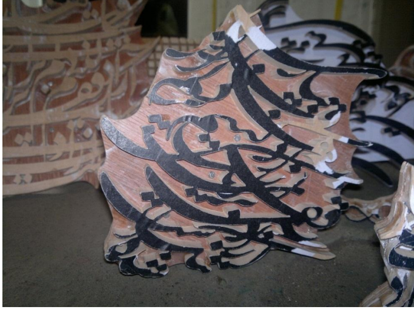
Şekil 43: Montaj İşlemi Yapılmış Kalıplar
