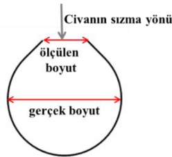
Şekil 3.8. Civa porozimetresinde ölçülen ve gerçek gözenek boyutunun şematik gösterimi
