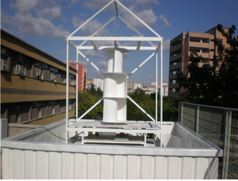
Şekil 2.24. Platformun su kanalı içinde yerleşimi
