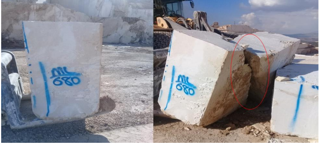
Şekil 4.15. Lastik tekerlekli yükleyicinin bloğu taşıırken oluşan hasar.
