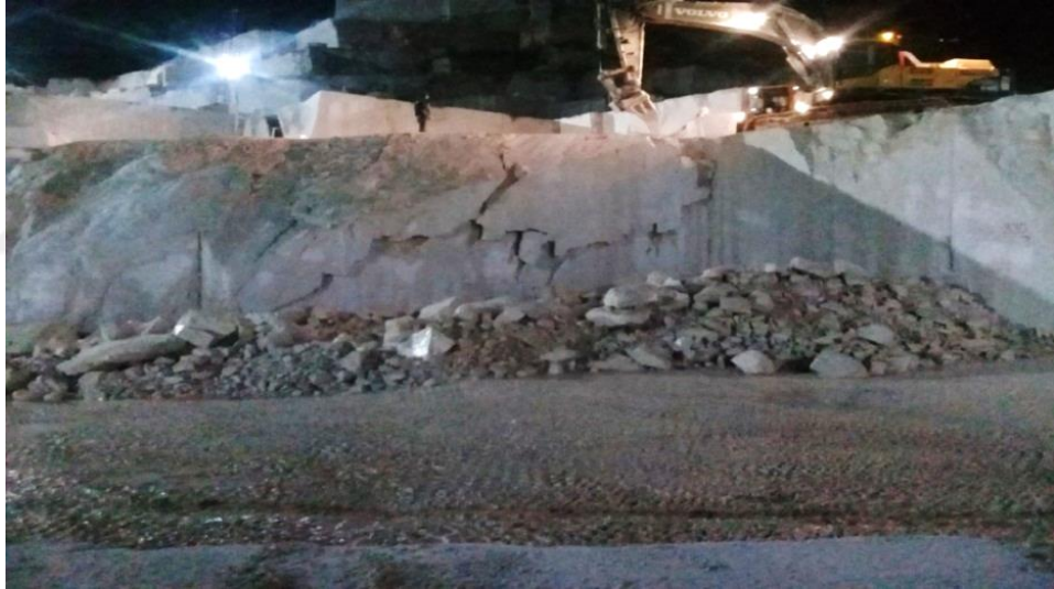
Şekil 4.9. Yanlış hazırlanan yastıklama örneği
