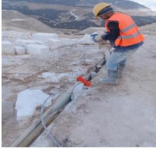
Şekil 4.4. Sac balon şişirilirken kesim açıklığının taşlarla desteklenmesi
