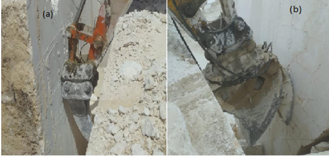
Şekil 4.6. Mermer ocaklarında kullanılan hidrolik ayırıcılar; riper (a) ve panter (b)
