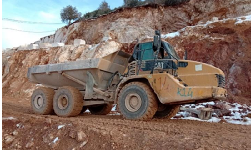
Şekil 5.4. Belden kırmalı kaya kamyonu
