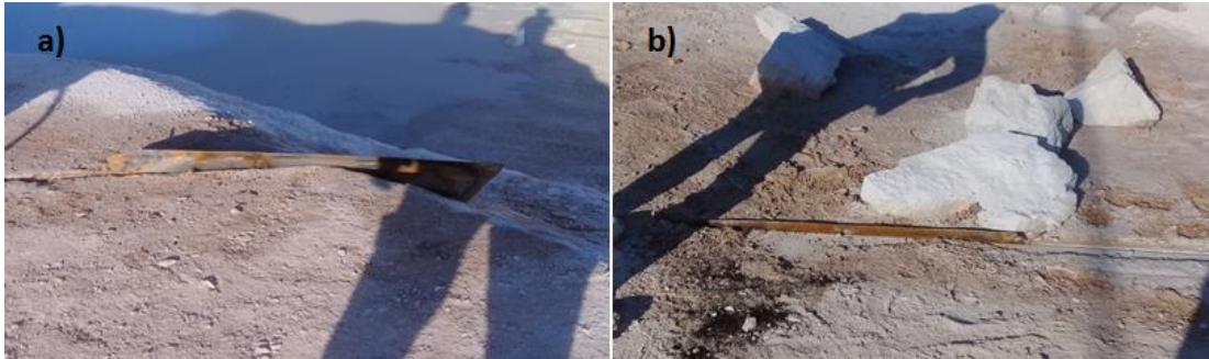
Şekil 4.5. Kesişe tamamen sokulmamış (a) ve sokulmuş (b) sac balon
