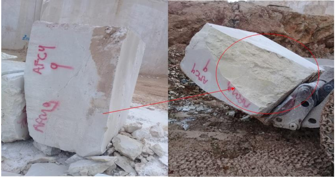
Şekil 4.14. Lastik tekerlekli yükleyicinin bloğu alırken oluşan hasar
