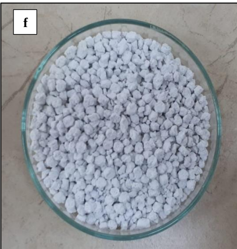
Şekil 3.2 Nano hidroksiapatitin hazırlanması (a-nano hidroksiapatitin sentezlenmesi, b-NaOH ile pH ayarı, c-nano hidroksiapatitin çöktürülmesi, d-nano hidroksiapatitin kurutulması, e-toz nano hidroksiapatit ve f-nano hidroksiapatit peleti)
