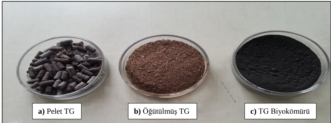
Şekil 3.4 Pelet tavuk gübresi (a), öğütülmüş tavuk gübresi (b) ve piroliz sonucu elde edilen BK'nın (c) görünümü
