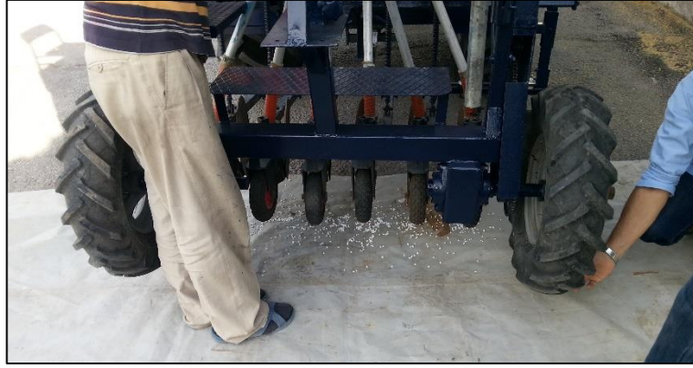
Şekil 3.3 Pelet nano hidroksiapatitin parsel mibzeri ile araziye uygulanabilirliğinin test edilmesi
