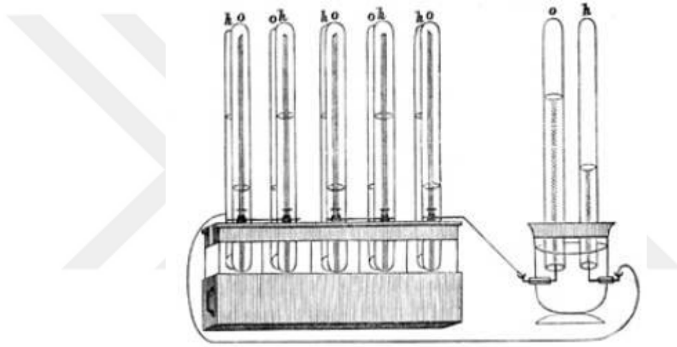
Şekil 2.4. Grove tarafından geliştirilen ilk yakıt hücresi -1839 [33]
