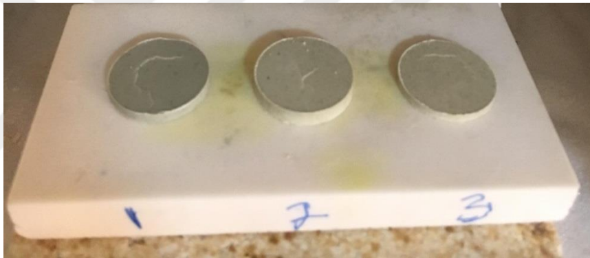
Şekil 4.5. Isıl işlem uygulanması için hazırlanmış numuneler
