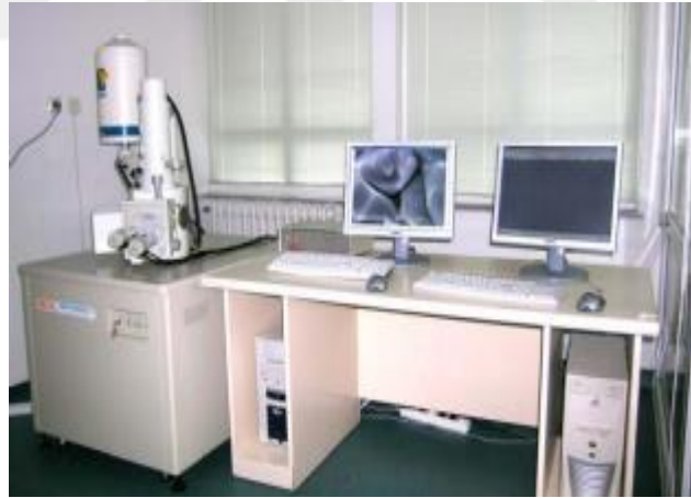
Şekil 4.8. Cam-seramik conta-akım toplayıcı ara yüzey incelemelerinde kullanılan SEM cihazı.
