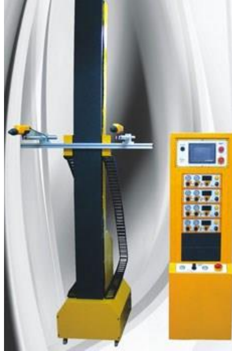
Şekil 1.21: Piyasada Kullanılan Kartezyen Toz Boya Robot Mekanizması – 2[17]
