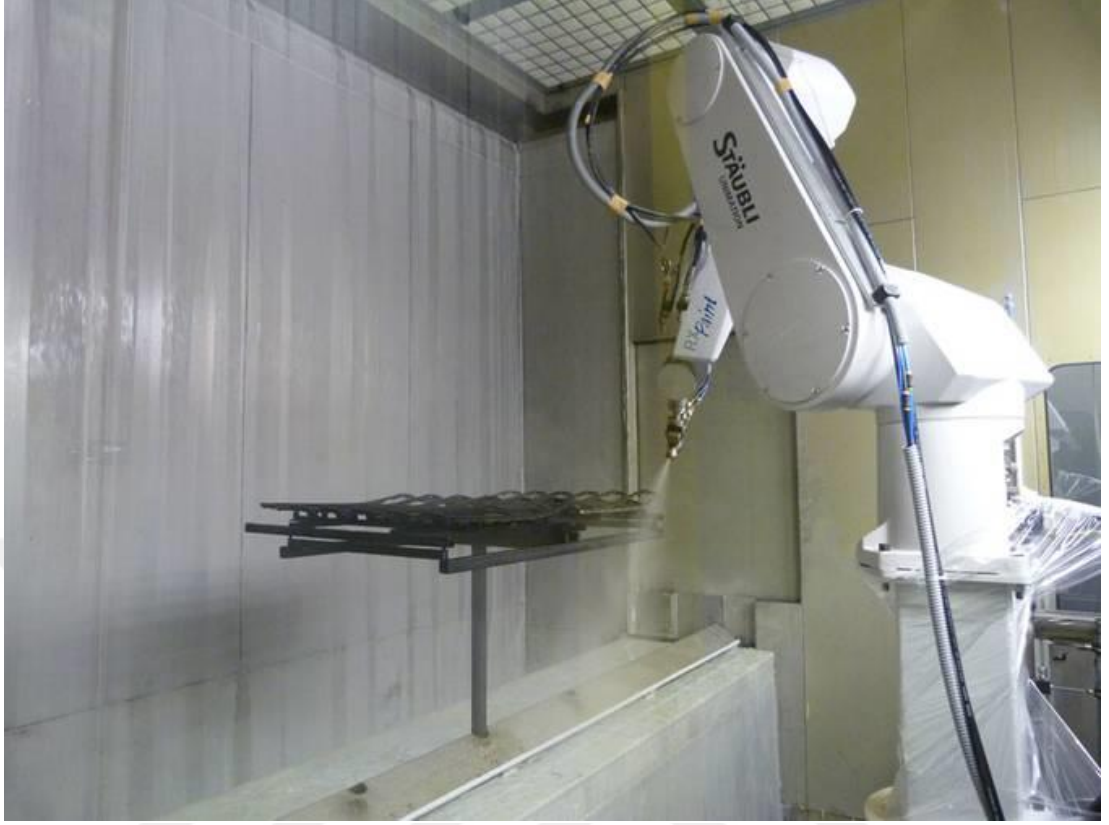
Şekil 1.22: Piyasada Kullanılan 6 Eksen Toz Boya Robot Mekanizması – 1[18]
