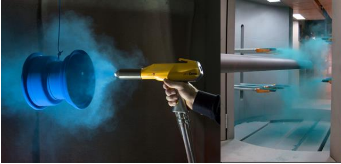
Şekil 1.14: Elektrostatik Toz Boya Uygulama Yöntemleri 1)Manuel 2)Otomatik[13]
