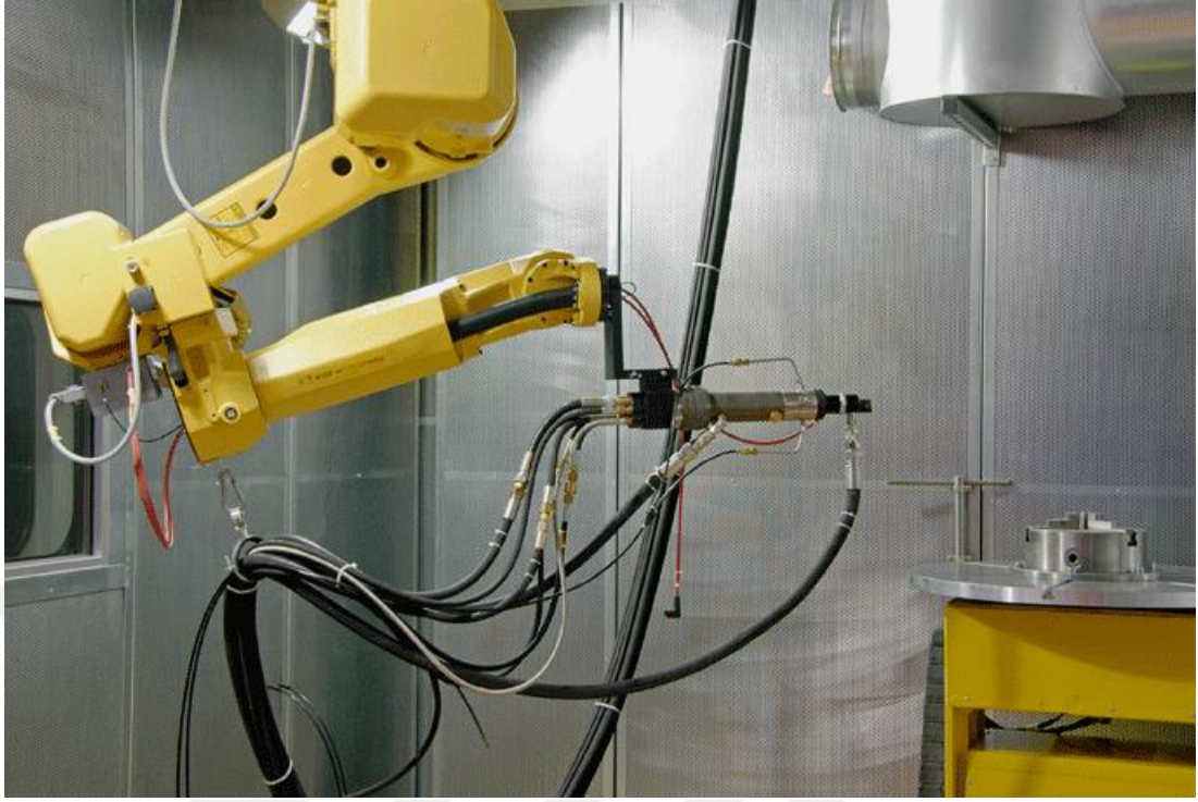
Şekil 1.23: Piyasada Kullanılan 6 Eksen Toz Boya Robot Mekanizması – 2[18]
