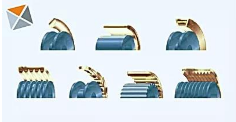
Şekil 2.22: Kayış-Kasnak Mekanizmasında Kullanılan Kayış Çeşitleri[28]
