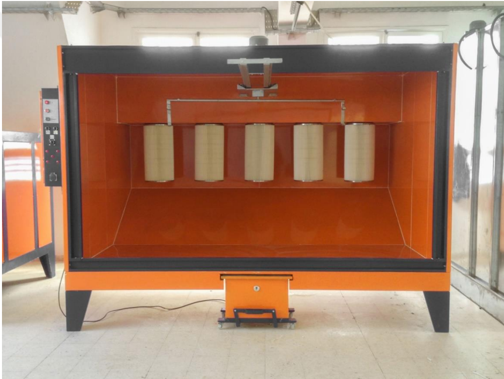
Şekil 1.9: Elektrostatik Toz Boya Kabini Filtre Düzeni[10]
