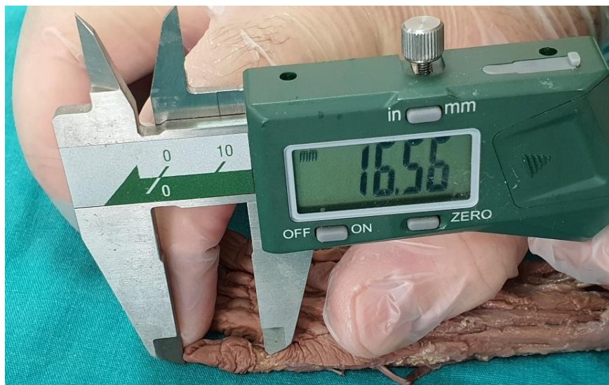
Şekil 2.2. Dijital kumpas ile digitus uzunluklarının ölçümü.
