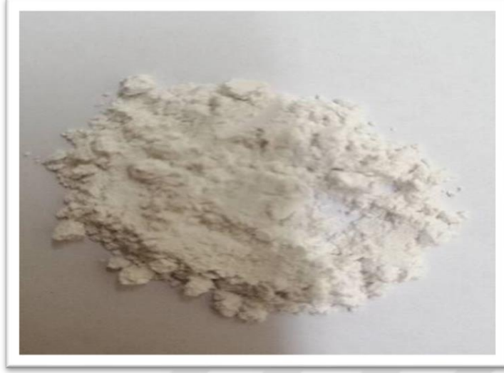
Şekil 3.2. Kalsinasyon işlemi sonrasında elde edilen hidroksiapatit
