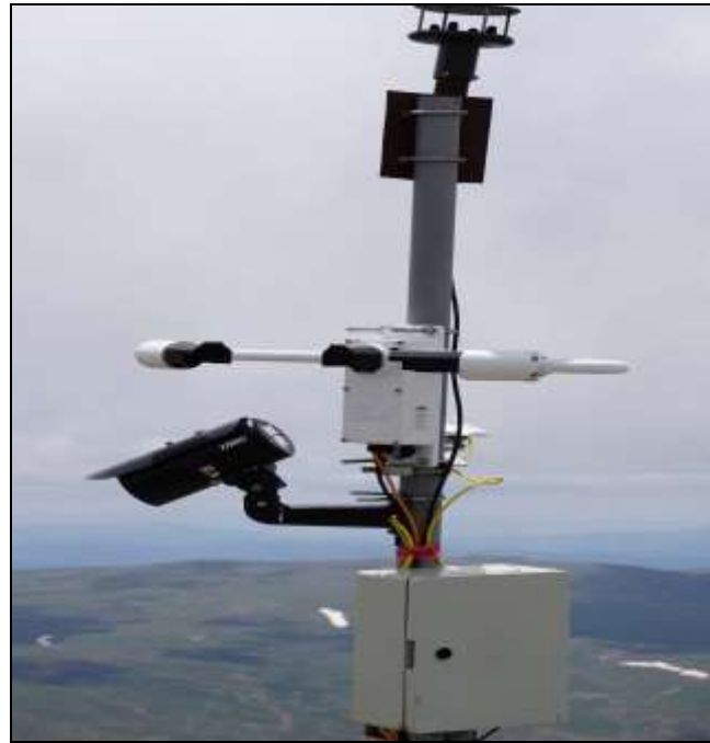
Şekil 47. AWS meteoroloji aletinin görüntüsü
