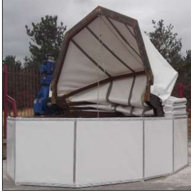
Şekil 33. DIMM sisteminde kullanılan açılır - kapanır çatı sistemi
