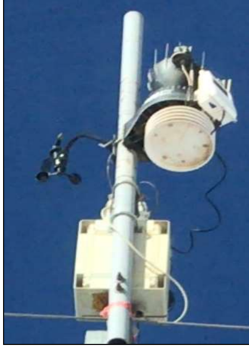
Şekil 49. DAVIS Vantage Pro2 meteoroloji sisteminin görüntüsü
