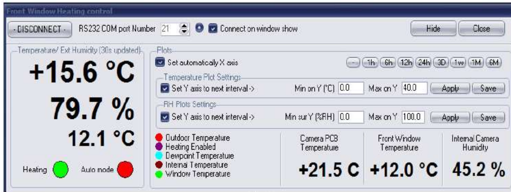
Şekil 27. CYCLOPE Görüş Ölçer sıcaklık ve nem değeri göstergesi
