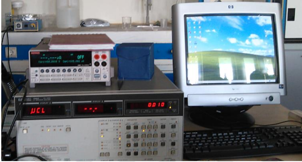
Şekil 3.4. Akım-voltaj ( I-V ) ve kapasite-voltaj ( C-V ) ölçüm sistemleri
