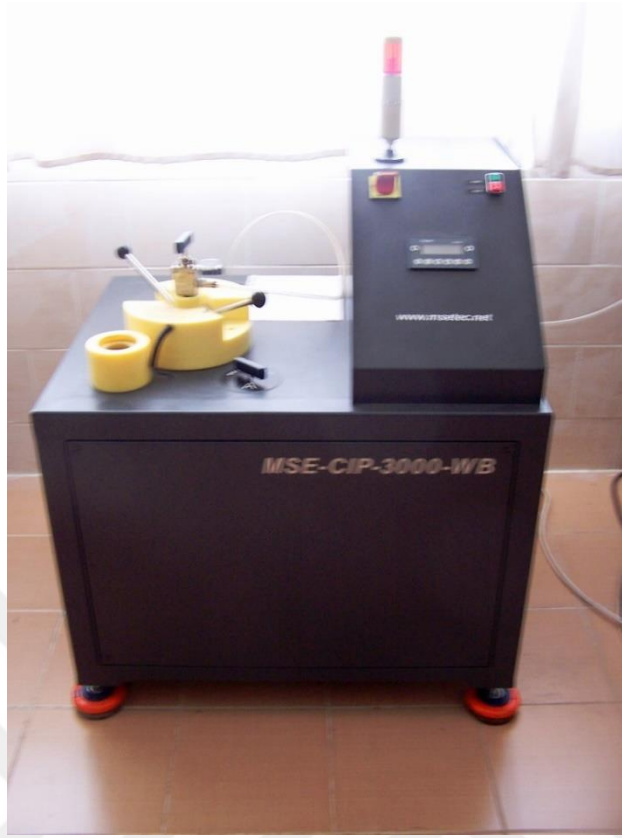
Resim 3.3 MSE-CIP-3000-WB markalı soğuk izostatik pres.
