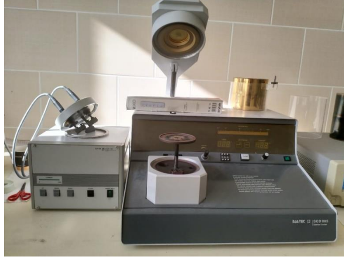
Resim 3.5 Baltec Sputtering SCD/005 markalı kaplama cihazı.
