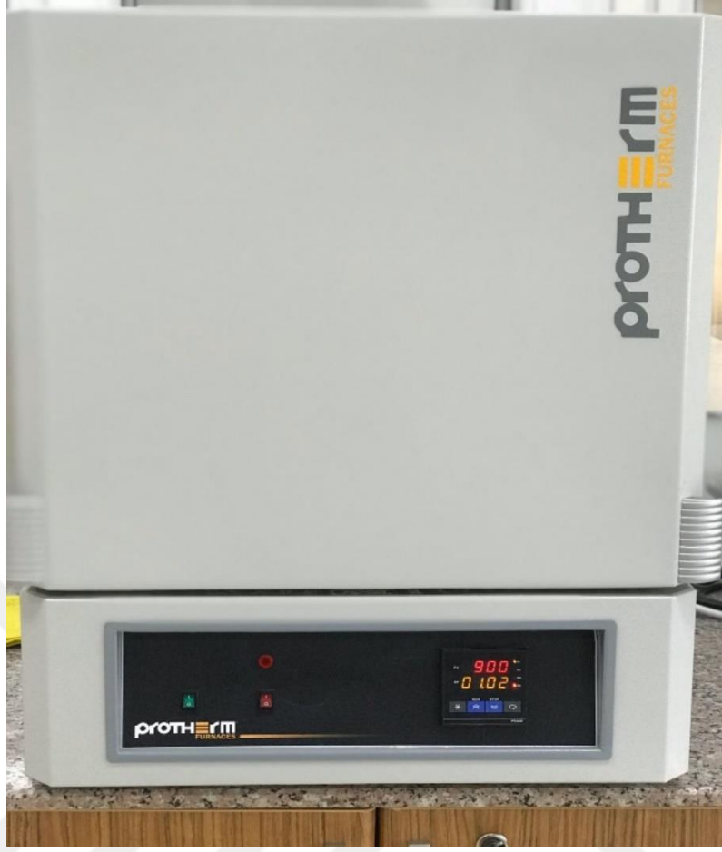
Resim 3.2 Yüksek sıcaklık ısıl işlemleri için kullanılan Protherm-PLF 130/12 markalı fırın.
