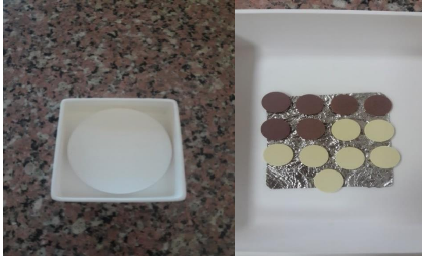
Resim 3.4 a) Sinterleme işlemi yapılacak platin altlıklı seramik kroze b)1150°C de 12 saat sinterlenmiş numuneler.
