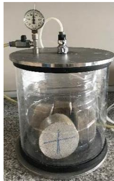
Şekil 3. 17 NT BUILD 492 klorür deneyi ön vakum işlemi
