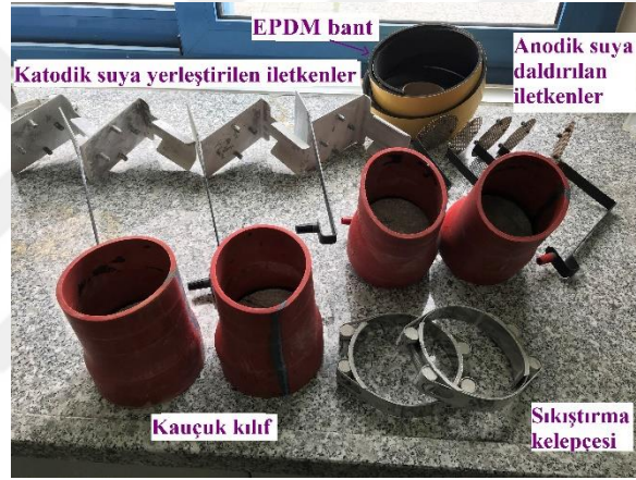
Şekil 3. 18 Klorür geçirirli deney aparatları
