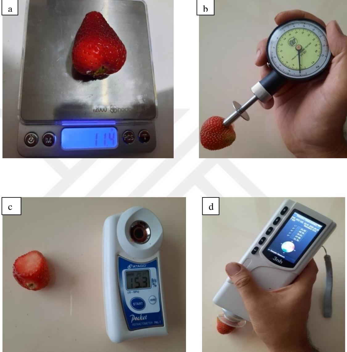
Şekil 3.6. Meyvelerde yapılan pomolojik analizlerden genel görünüm. Meyve ağırlığı (a); Meyve Et Sertliği (b); Suda Çözünabilir Kuru Madde (c); Renk Ölçümü (d)
