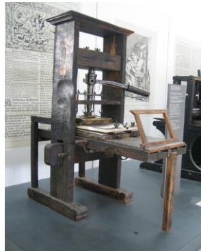
Resim 10: Johannes Gutenberg'in 1440 yılında geliştirdiği tipo baskı makinesi (History of Innovation, 2021, s.1).
