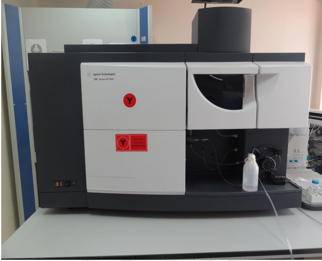
Şekil 3.1 : Ağır metal analizleri için kullanılan Endüktif Eşleşmiş Plazma Optik Emisyon Spektrometresi (720, Agilent Tech).
