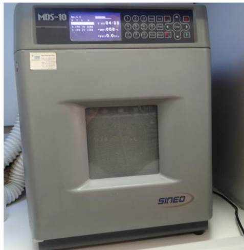
Şekil 3.2 : SINEO MDS-10 model mikrodalga fırın.
