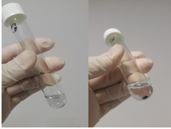
Şekil 3.8 Solda aktivite tayin tüpündeki vortekslenmiş immobilize enzimler, sağda mıknatısla dipte toplanmış immobilize enzimler.
