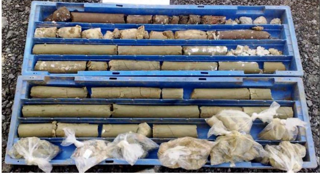
Şekil 6.22. Zeytinburnu İlçesinde yapılan deneylerin bulunduğu sahaya ait karot sandığı [34].
