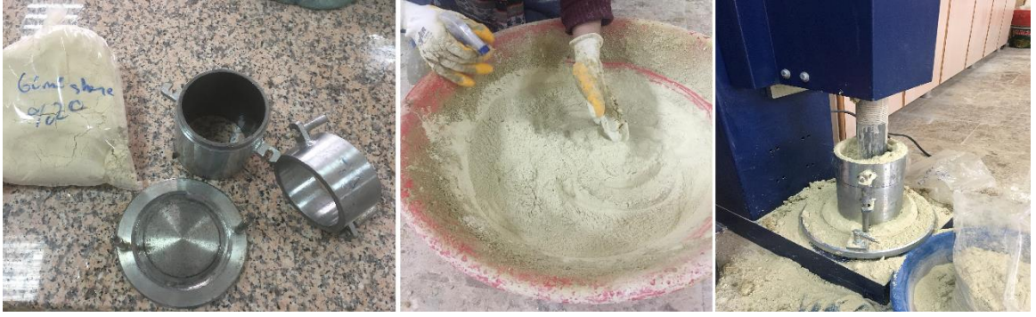
Şekil 4.6. Zemin örneğinin hazırlanması ve sıkıştırılması
