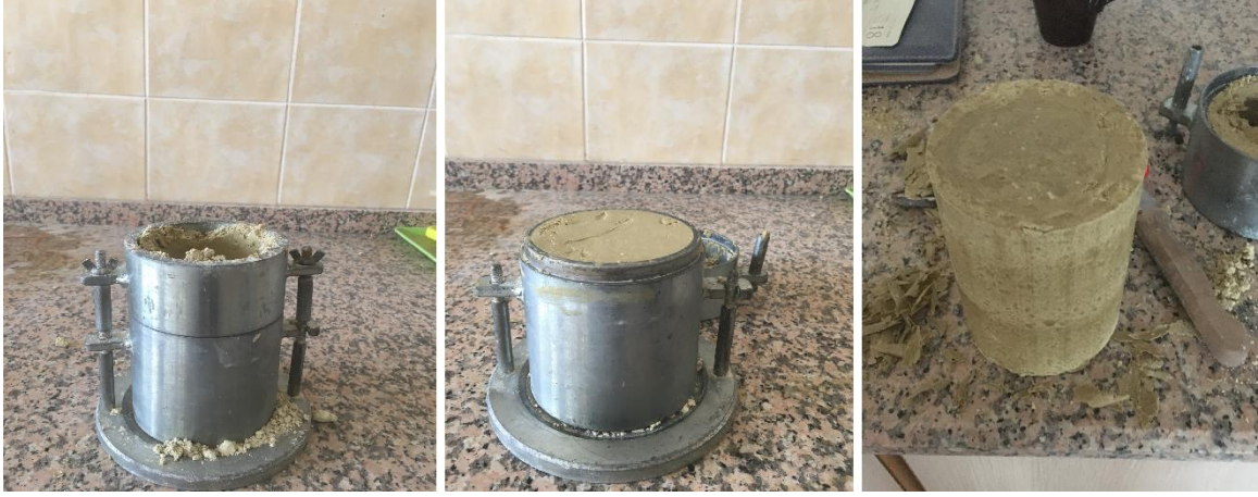
Şekil 4.7. Zemin örneğinin kalıptan çıkarılması
