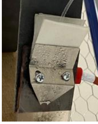
Şekil 3.21: Elektrolit çözeltinin numune yüzeyine düzgün dağılması için 8 katlı whatman tipi filtre kâğıdının yüksek gerilim elektrotu ile numune arasına sıkıştırılmış görüntüsü.
