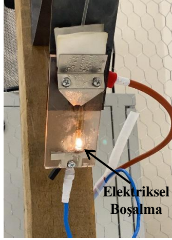
Şekil 3.27: Deney sırasında alt elektroda yakın yüzeylerde meydana gelen elektriksel boşalmaların görüntüsü.
