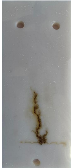
Şekil 4.4: İz oluşumu deneyini tamamlamış %3 çinko oksit katkılı polyester numune görüntüsü
