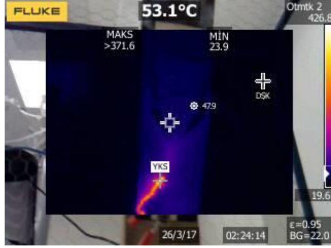
Şekil 4.15: %3 nikel katkılı polyester numune üzerinde bozulmanın meydana geldiği anda sıcaklığı gösteren termal kamera görüntüsü.
