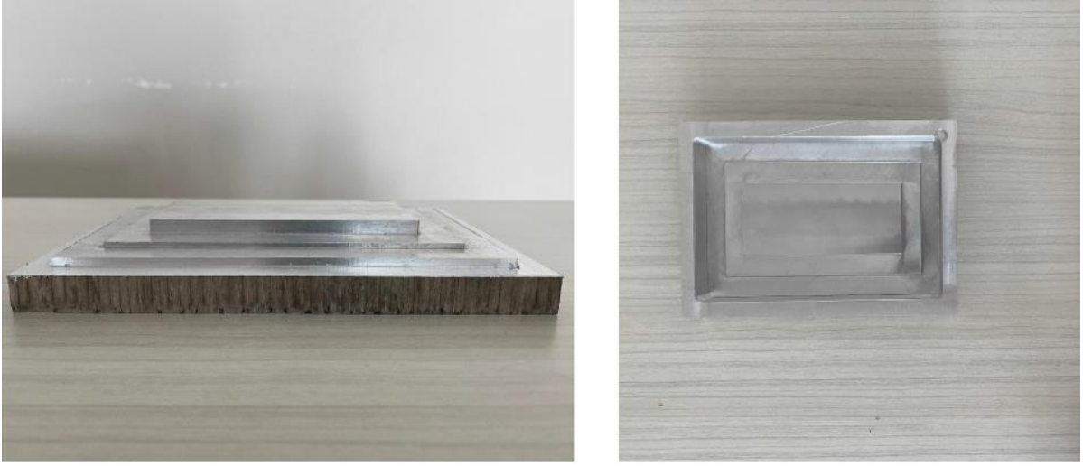
Şekil 3.3: Alüminyumdan üretilen kalıbın (a) yandan ve (b) üstten görünümü.
