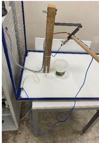
Şekil 3.28: Sistemin enerjisi kesildikten sonra iletken kısımlarda kalan yüklerin stanca ile toprağına aktarılmasının görüntüsü.
