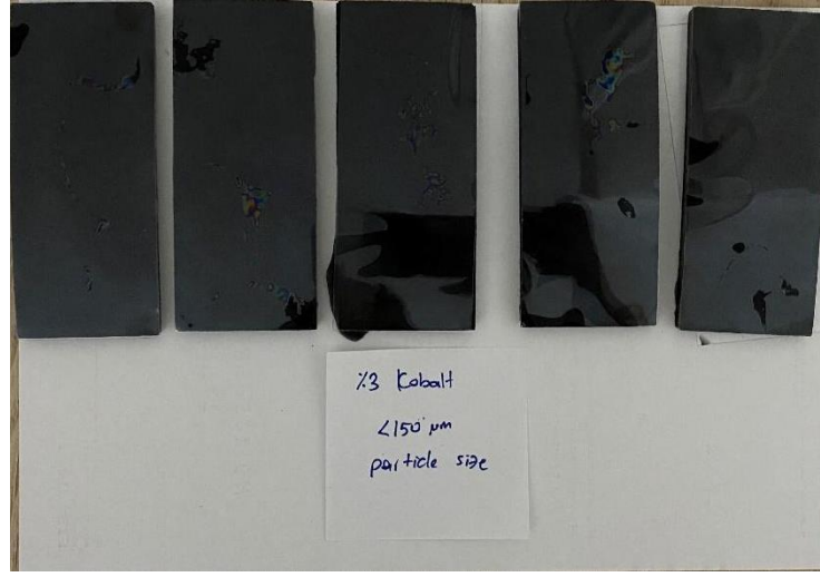
Şekil 3: Tanecik boyutu 150 \mu\text{m} 'den küçük olan %3 kobalt katkılı polyester numune
