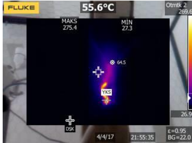
Şekil 4.3: Saf polyester numune üzerinde bozulmanın meydana geldiği andaki sıcaklığı gösteren termal kamera görüntüsü.
