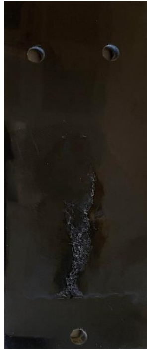
Şekil 4.7: İz oluşumu deneyini tamamlamış %3 kobalt katkılı polyester numune görüntüsü
