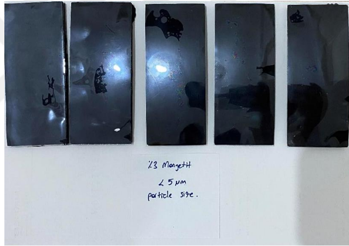
Şekil 4: Tanecik boyutu 5 \mu\text{m} 'den küçük olan %3 manyetit katkılı polyester numune
