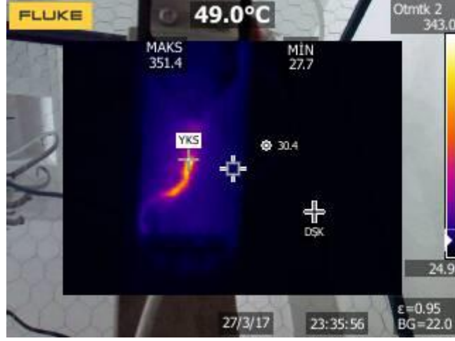
Şekil 4.12: %3 manyetit katkılı polyester numune üzerinde bozulmanın meydana geldiği andaki sıcaklığı gösteren termal kamera görüntüsü.
