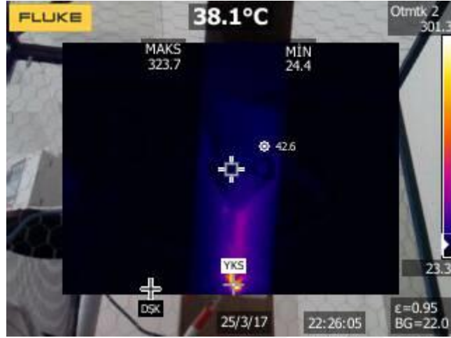
Şekil 4.6: %3 çinko oksit katkılı polyester numune üzerinde bozulmanın meydana geldiği andaki sıcaklığı gösteren termal kamera görüntüsü.
