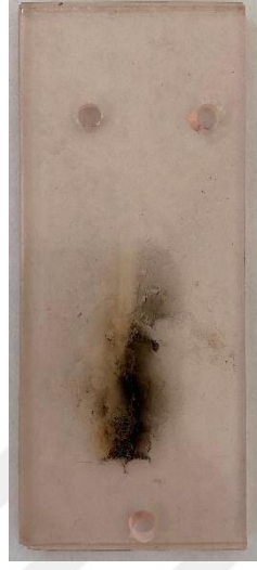
Şekil 3.1: Deney sonucunda yüzeyinde karbon iz oluşmuş numunenin yüzey görüntüsü.
