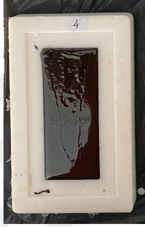
Şekil 3.14: Sertleşmenin başlamasının ardından silikon kalıba dökülen katkılı polimerlerin yüzeyinde meydana gelen dalgalanmanın görüntüsü.
