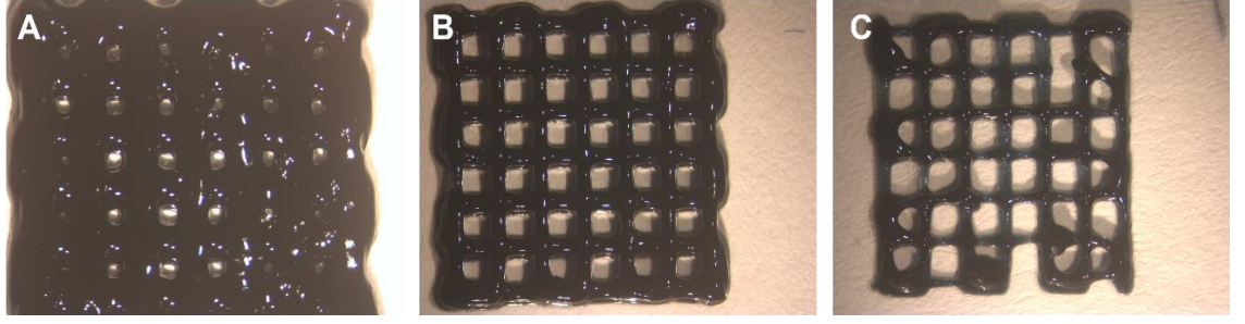
Şekil 3.8. %8 (w/v) Aljinat %15 (w/v) Pluronik F-127 biyomürekkebinin sıcaklık optimizasyonu A) 20 °C, B) 26 °C, C) 37 °C
