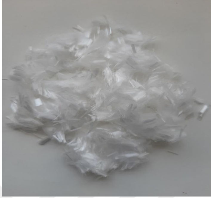
Şekil 3. 5. 6 mm uzunluğunda polipropilen lif
