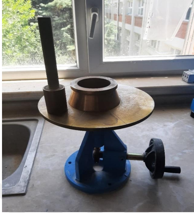
Şekil 3. 8. Çimento yayılma tablası tokmak ve kalıp
