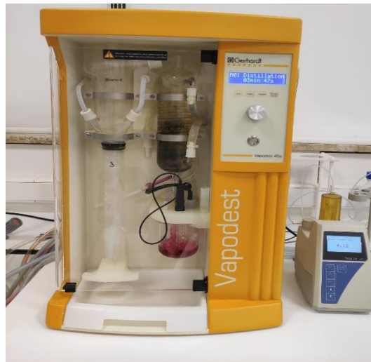
Şekil 3.3. Analizde kullanılan protein cihazının titrasyon ünitesi
