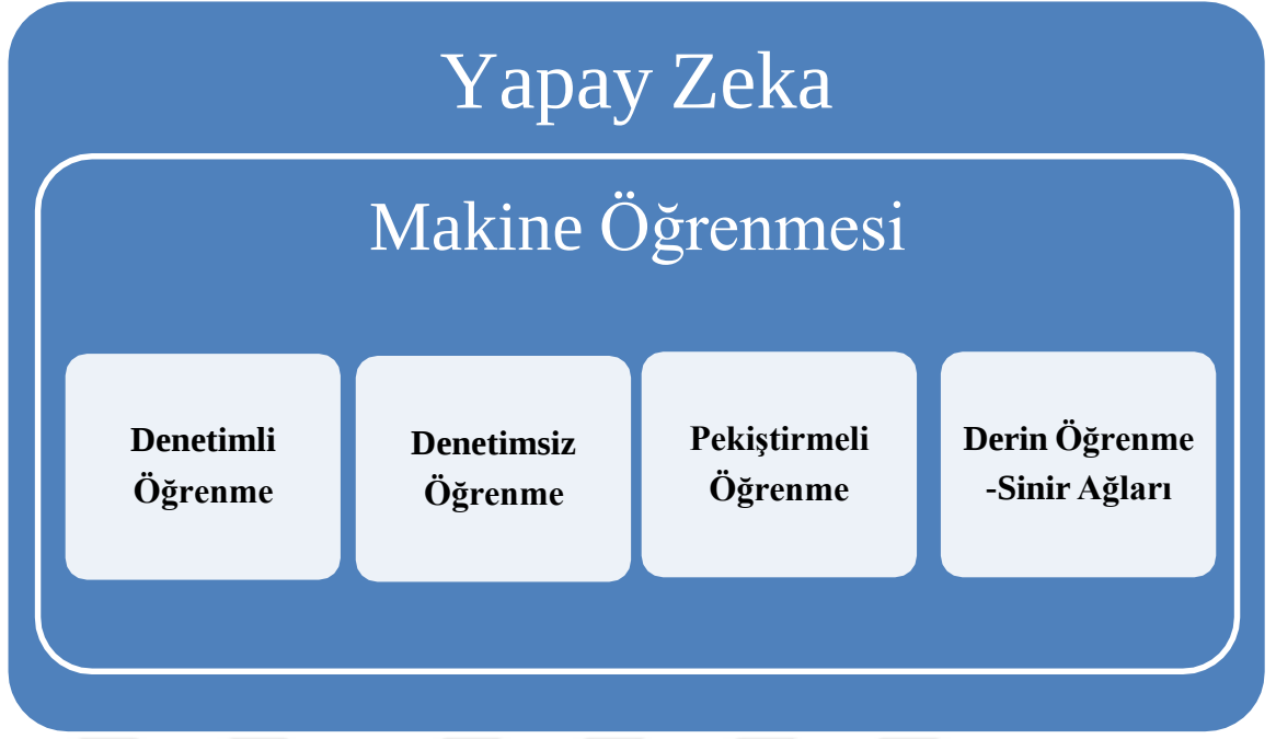
Şekil 2.18. Yapay zeka, makine öğrenmesi ve derin öğrenme ilişkisinin gösterildiği diagram (151).
