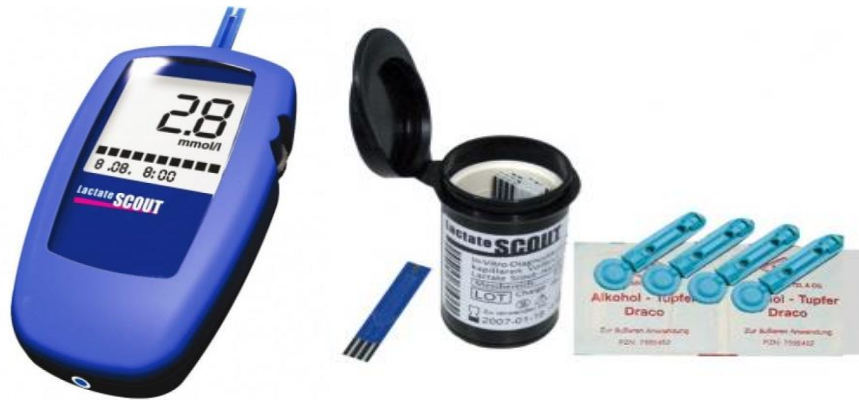
Şekil 2.2. Laktat Scout marka laktat analizörü, laktat ölçüm sensörü ve striptler.
