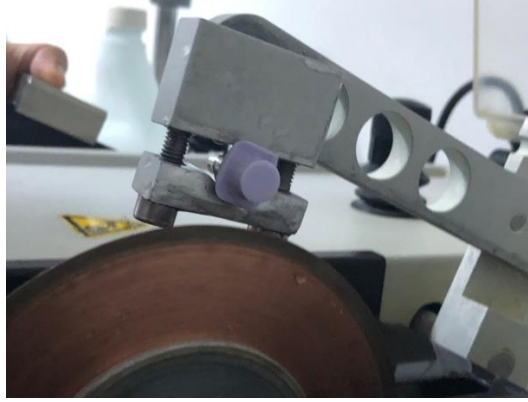
Resim 16: Hassas Kesme Cihazında TP için hazırlanan lityum disilikat ile güçlendirilmiş seramik örneklerin 1 mm kalınlıkta dilimlenmesi
