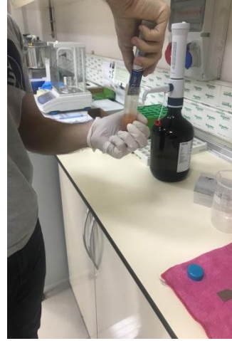
Şekil 3. 4. Asetonitril (% 1'lik asetik asit)(a) magnezyum sülfat + sodyum asetat eklenmesi(b)
