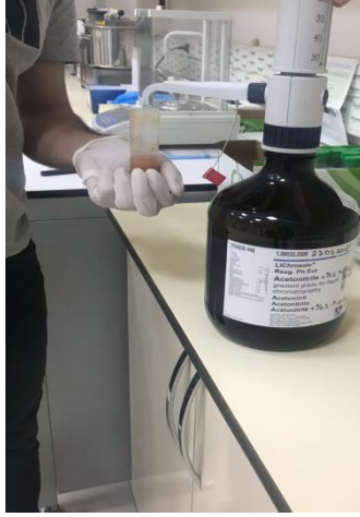
Şekil 3. 4. Asetonitril (% 1'lik asetik asit)(a) magnezyum sülfat + sodyum asetat eklenmesi(b)
