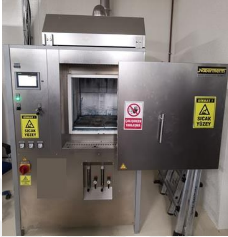
Görsel 5.16. Oksidasyon testleri için kullanılan ısı işlem fırını
