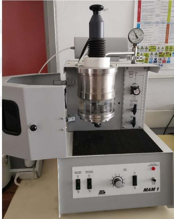
Görsel 5.4. Numune üretimlerinde kullanılan vakum ark ergitme cihazı
