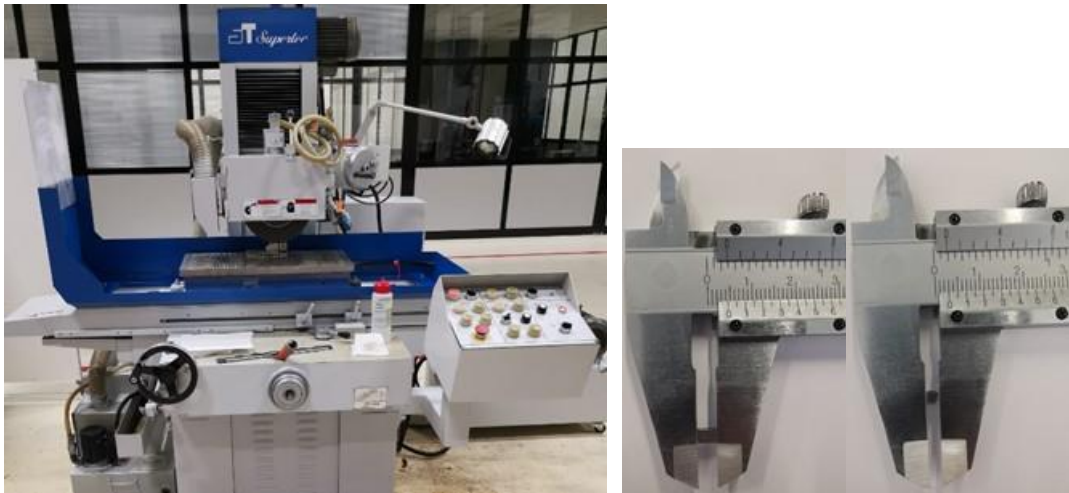
Görsel 5.13. Basma numunelerinin taşlanması için kullanılan satıh taşlama tezgahı (solda) ve taşlanmış numune ölçüleri (sağda)
