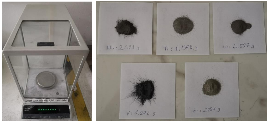
Görsel 5.1. Toz hammalzemelerin tartıldığı hassas terazi (solda) tartılan tozlara ait görüntü (sağda)
