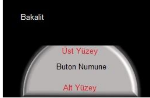
Görsel 5.9. Mikroyapı incelemelerinde bütün numunelerin bakalite alınma şekli
