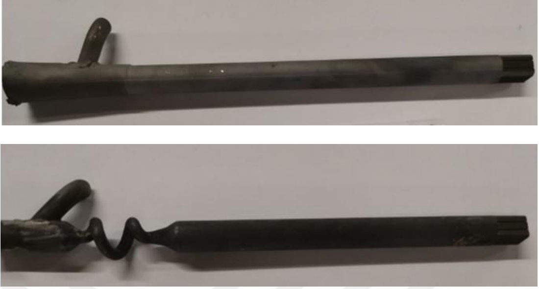
Görsel 5.7. Karşılaştırma amaçlı Tübitak MAM'dan tedarik edilen yönlendirilmiş katılaşma (üstte) ve tek kristal (altta) döküm çekme çubukları
