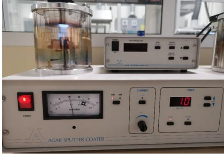
Görsel 5.10. SEM incelemeleri öncesinde bakalite alınan numunelerin kaplandığı altın kaplama cihazı
