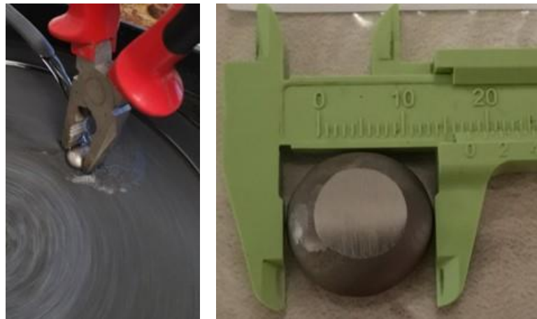
Görsel 5.8. Buton numune alt-üst yüzey zımparalaması (solda), zımpara sonrası numune üst yüzeyi (sağda)
