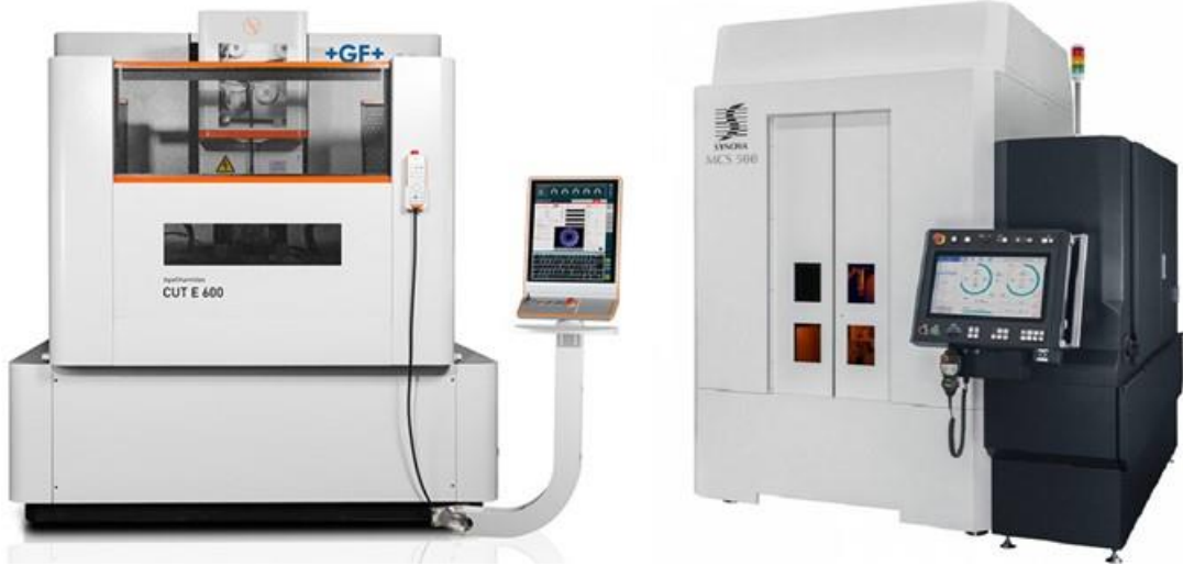
Görsel 5.11. Basma test numunelerinin kesiminde kullanılan tel erozyon (solda) ve lazer mikrojet (sağda) tezgahları
