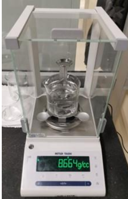
Görsel 5.18. Arşimet prensibi ile yoğunluk ölçümünde kullanılan hassas terazi
