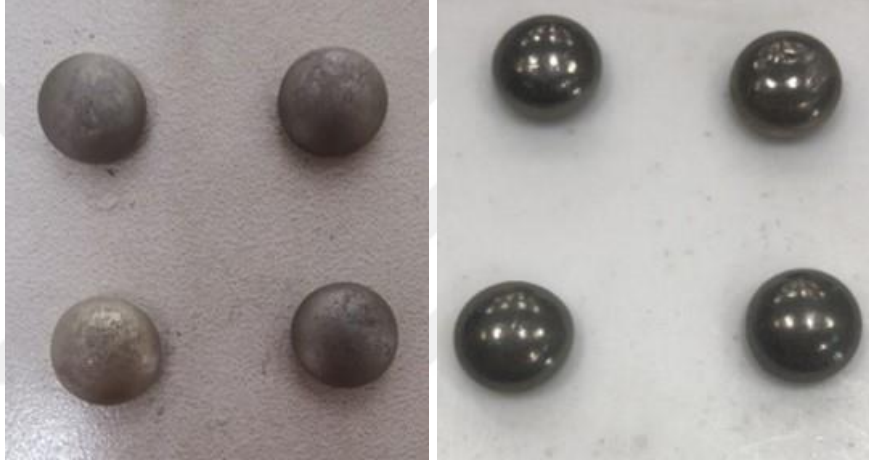
Görsel 5.15. Yüzey iyileştirme öncesi ve sonrası 5 gramlık buton numune görüntüleri
