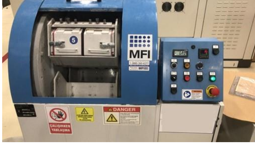
Görsel 5.14. Oksidasyon testi öncesi numunelerin yüzey iyileştirmeleri için kullanılan tezgah
