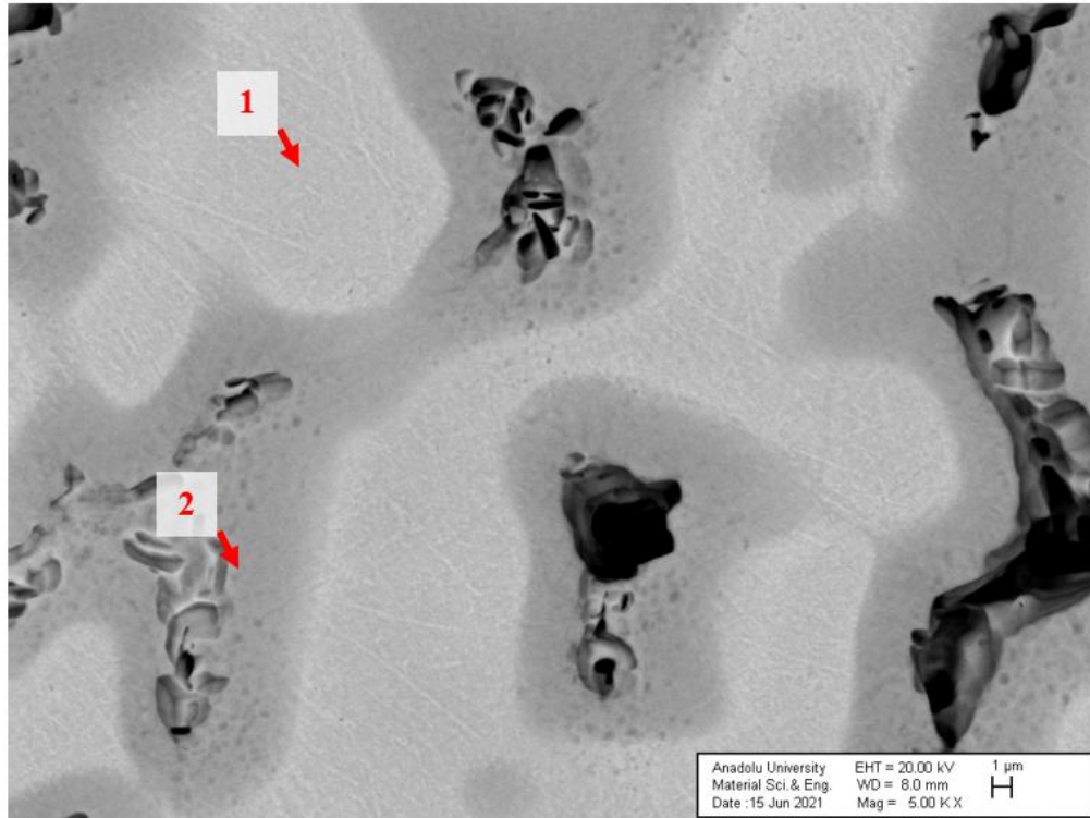
Şekil 6.20. 1400°C sıcaklıkta 24 saat ısıt işlem uygulanmış MoNbTiWV (RYEA-2_HT) alaşımına ait SEM mikroyapı görüntüsü (büyütme oranı: 5000x)
