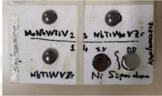
Görsel 6.2. 800°C sıcaklıkta gerçekleştirilen oksidasyon testi öncesi numunelerin görüntüsü
