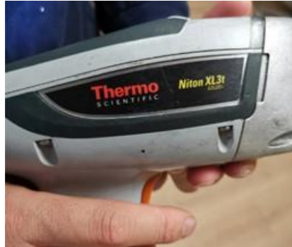
Görsel 5.17. Numunelerin kimyasal kompozisyon analizlerinde kullanılan XRF cihazı
