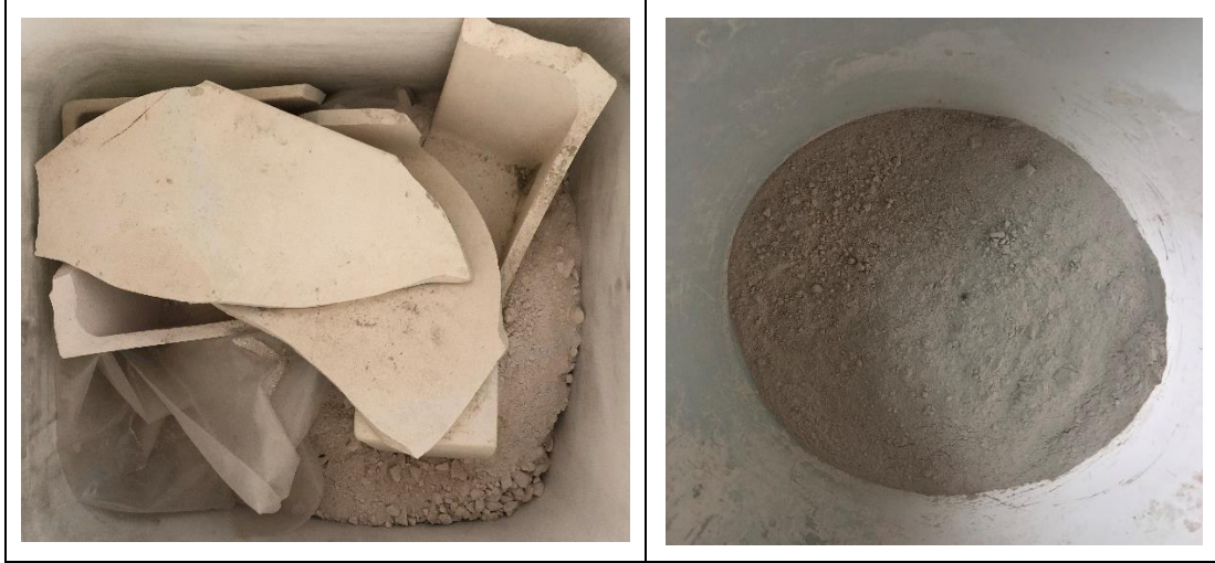
Şekil 2.14 : Gaz beton üretimde kullanılan seramik atıklar.
