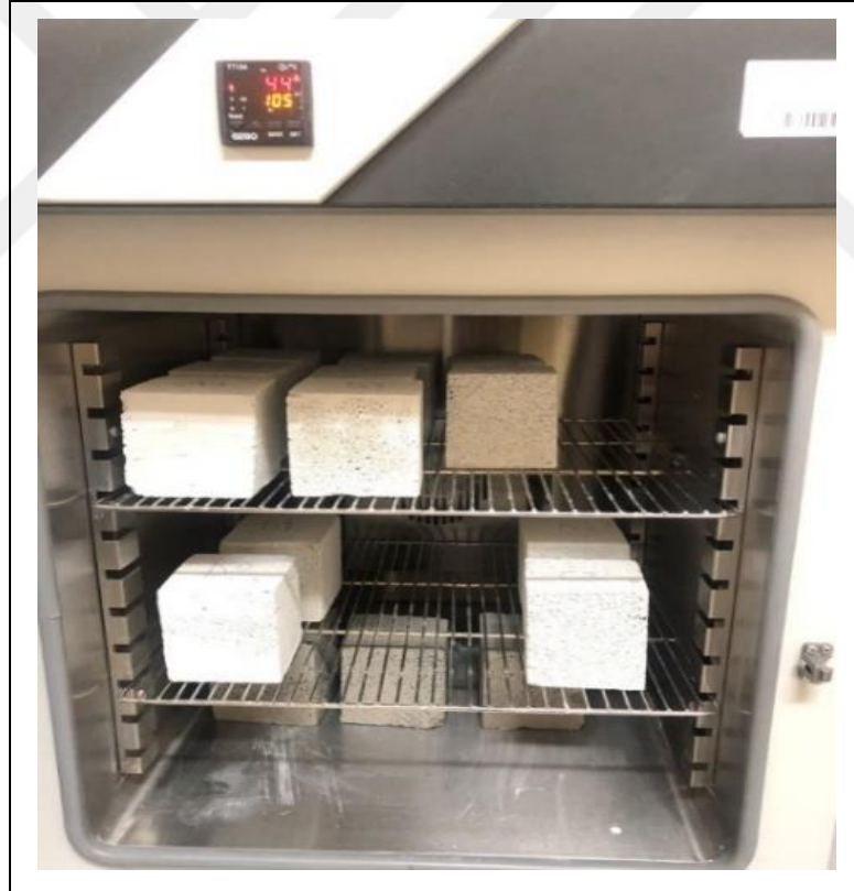
Şekil 3.42 : Basınç dayanımı için numuneleri kurutma işlemi.
