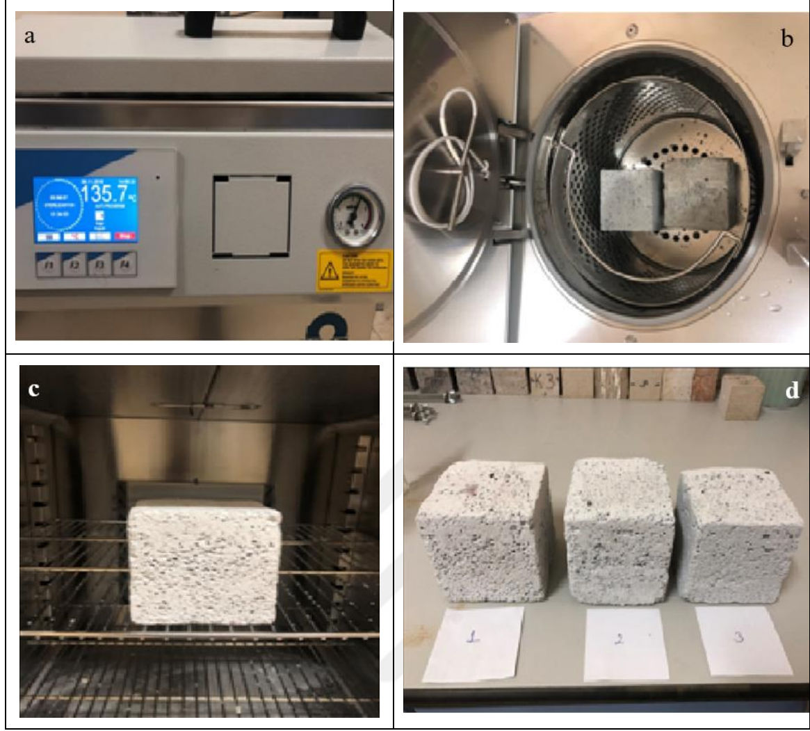
Şekil 3.37 : Deney numunelerinin kürlenme aşaması (a,b) ve nihai ürün (c,d).
