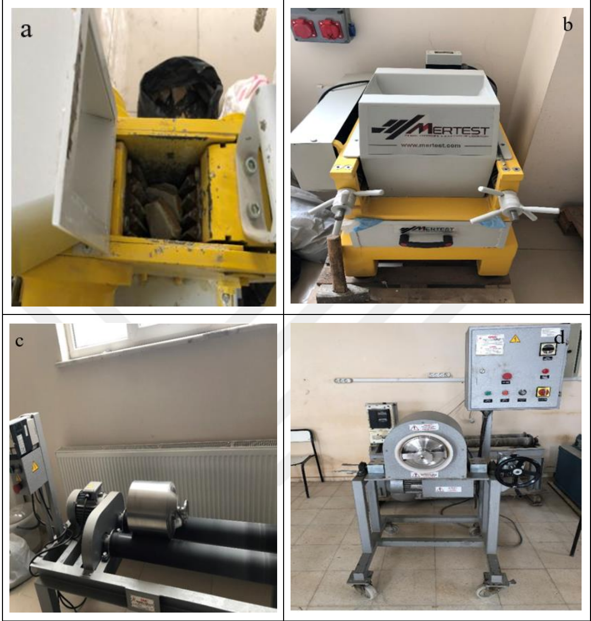
Şekil 3.1 : Gaz beton üretiminde kullanılan çeneli kırıcı (a), merdaneli kırıcı (b), bilyalı değirmenlere (c, d) ait görüntü.
