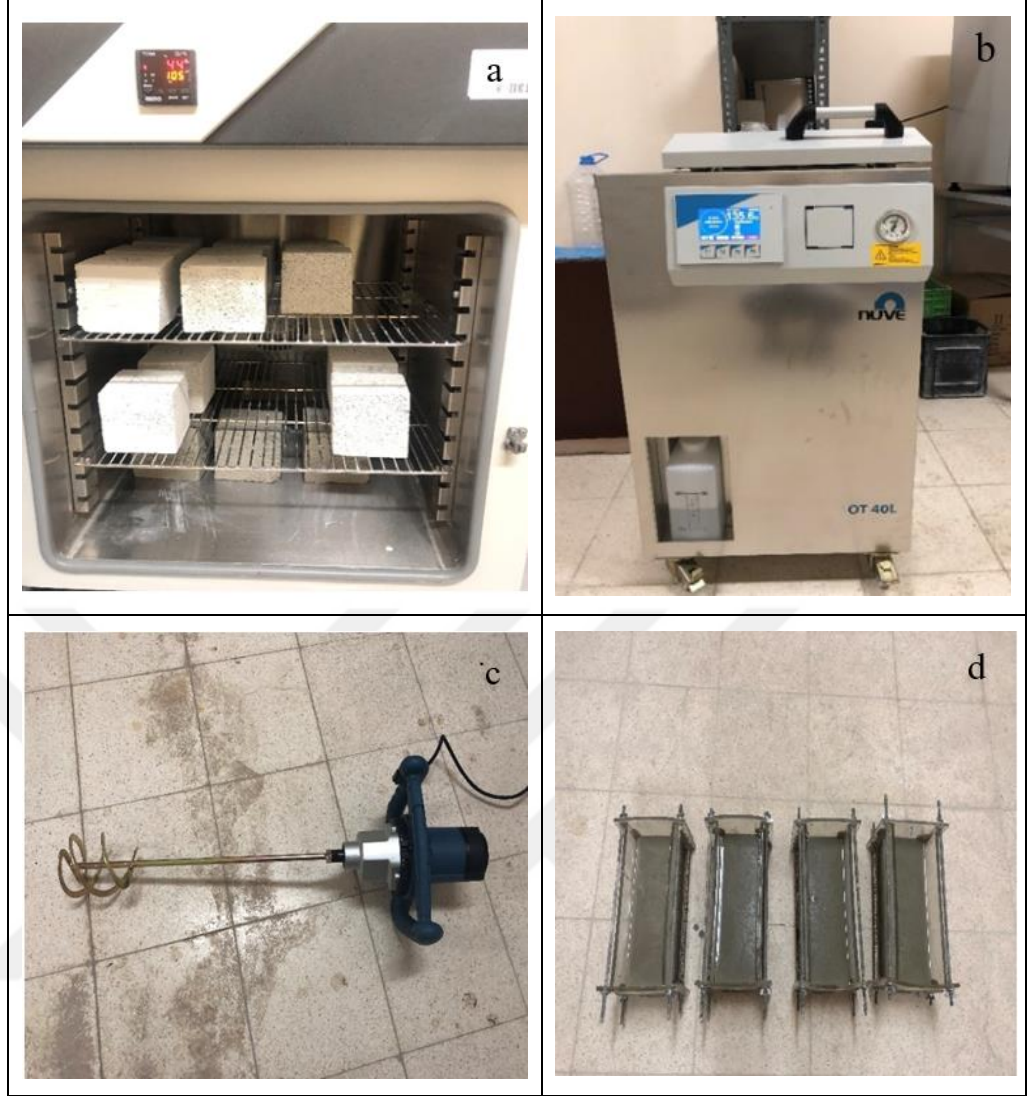
Şekil 3.3 : Gaz beton üretiminde kullanılan etüv (a), otoklav (b), mikser (c), beton kalıplarına (d) ait görüntü.
