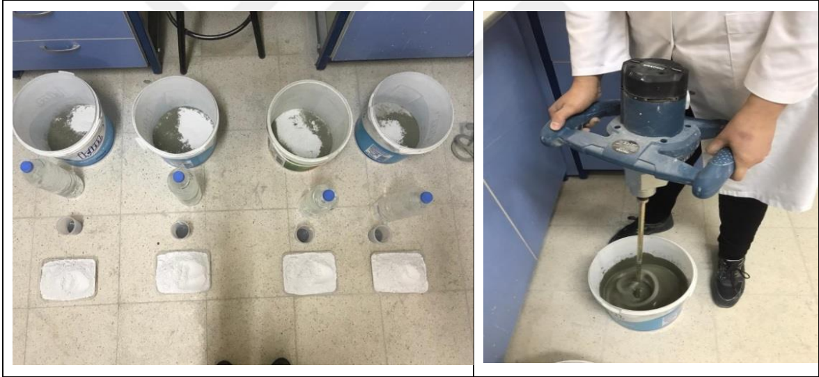
Şekil 3.35 : Deney numunelerinin hazırlanıp karıştırma aşaması.
