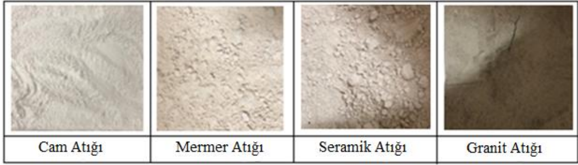
Şekil 3.4 : Gaz beton üretiminde kullanılan atıkların görüntüsü.
