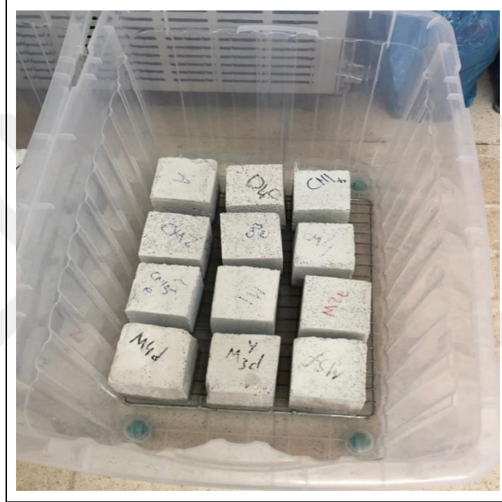
Şekil 3.41 : Gaz beton numunelerin kapiler su emme değerlerinin belirlenmesi.
