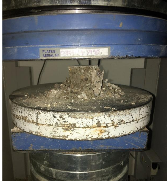
Şekil 4.8 : 750°C yangın sonrası suda soğutulan numuneye uygulanan basınç dayanımı deneyi sonrası görülen dağılma.
