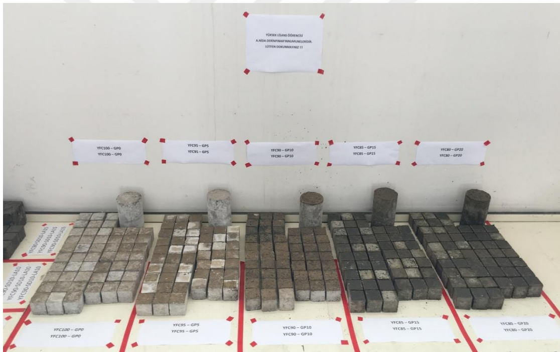
Şekil 3.11 : Geopolimer beton numunelerinin kür edilmesi.
