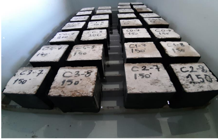
Şekil 3.13 : Kılcal geçirimsizlik deneyi düzeneğindeki geopolimer beton numuneler.
