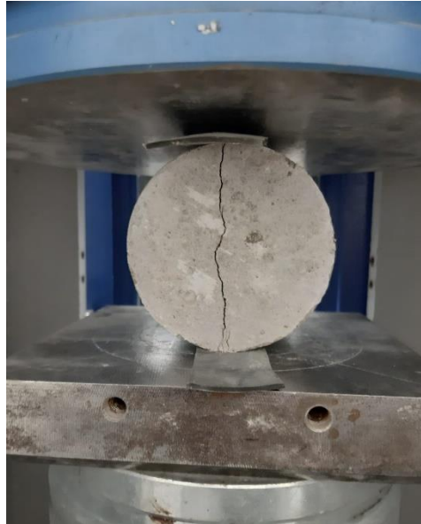
Şekil 3.16 : Yarmada çekme dayanımı deneyi uygulanan geopolimer beton numune.
