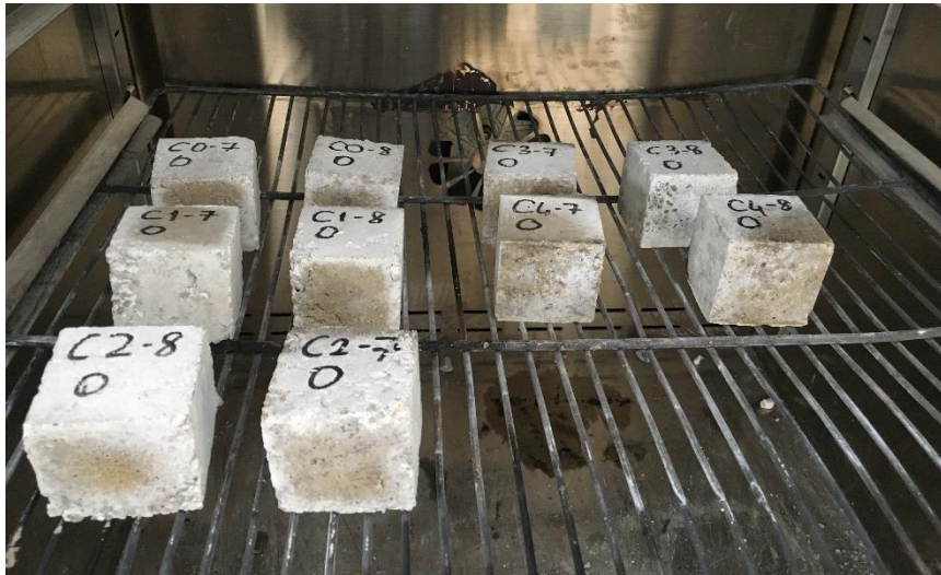
Şekil 3.12 : Kılcal geçirimlilik deneyi için etüvde bekletilen geopolimer beton numuneler.
