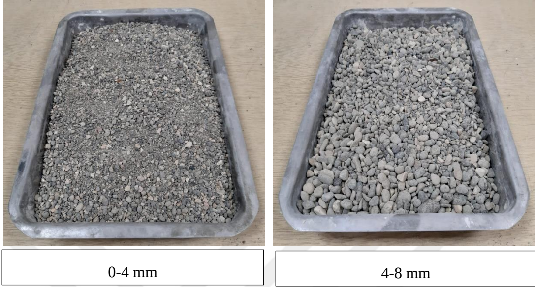
Şekil 3.4 : İnce ve iri agrega.
