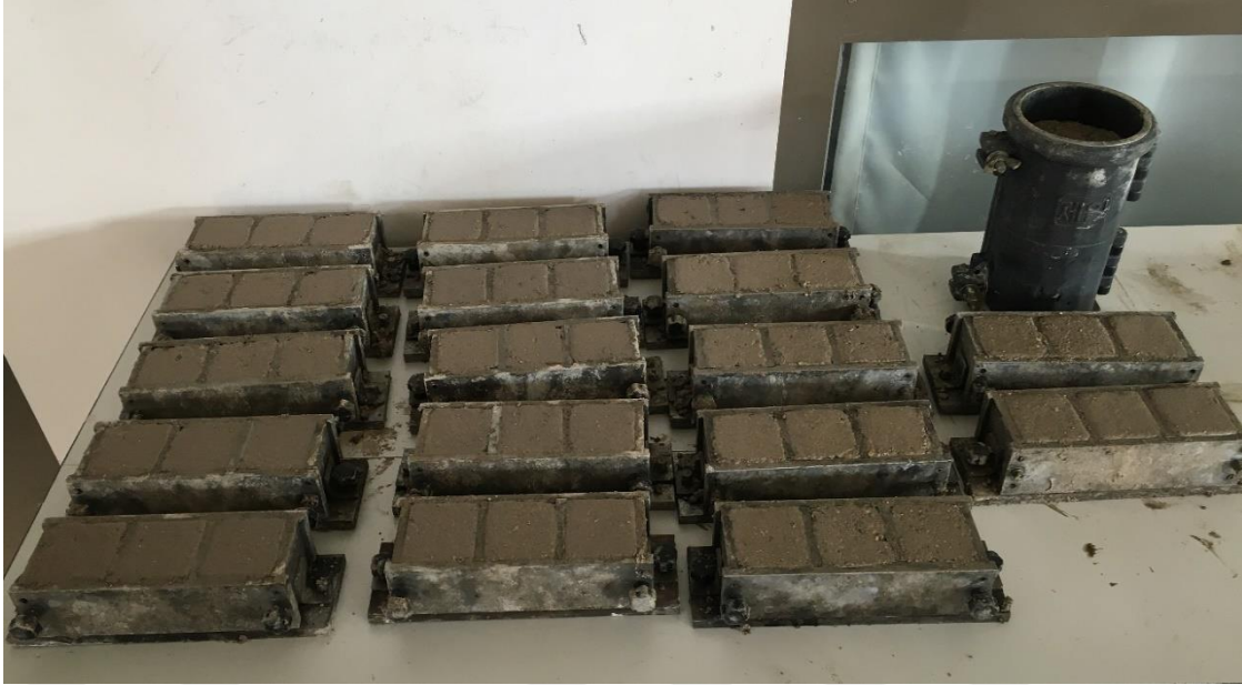
Şekil 3.10 : Kalıplara yerleştirilmiş geopolimer beton numuneler.
