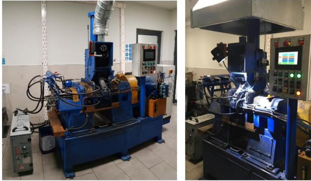
Görsel 6.3. Deney kauçuk karışımlarının hazırlanmasında kullanılan laboratuvar ölçekli mikser görüntüsü
