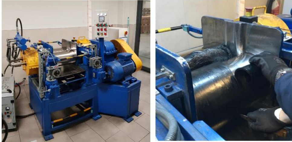
Görsel 6.1. Deney kauçuk karışımlarının hazırlanmasında kullanılan laboratuvar ölçekli mil görüntüsü
