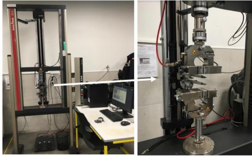
Görsel 6.11. Laboratuvar Zwick/Roel Z010 tensometre görüntüsü
