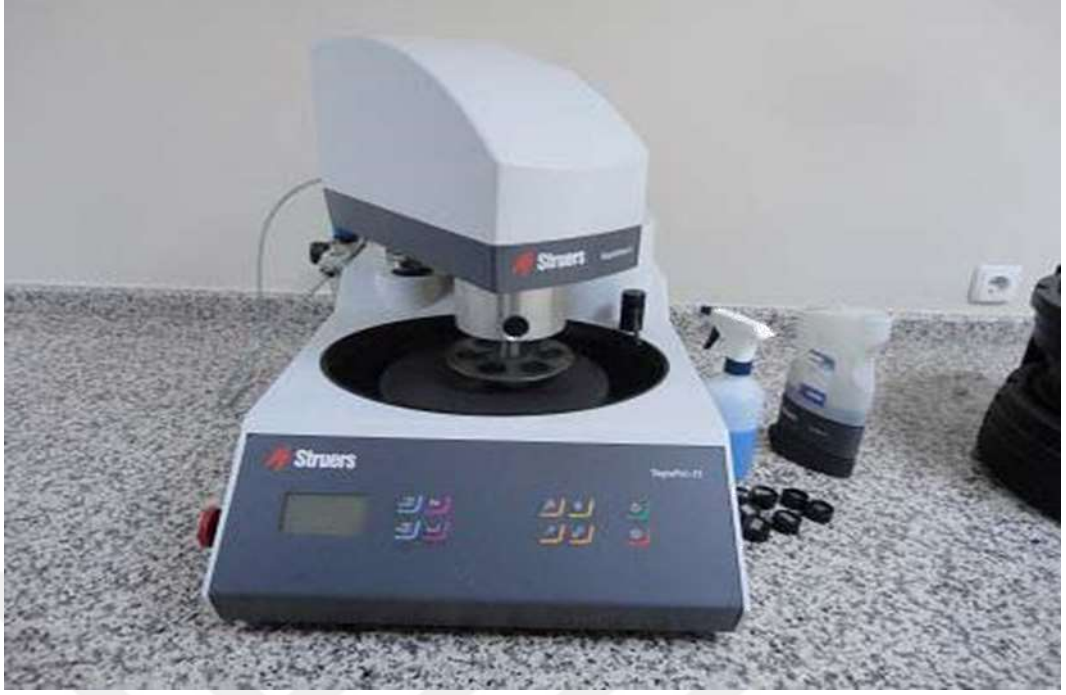
Şekil 3.3. Otomatik parlatma cihazı.
