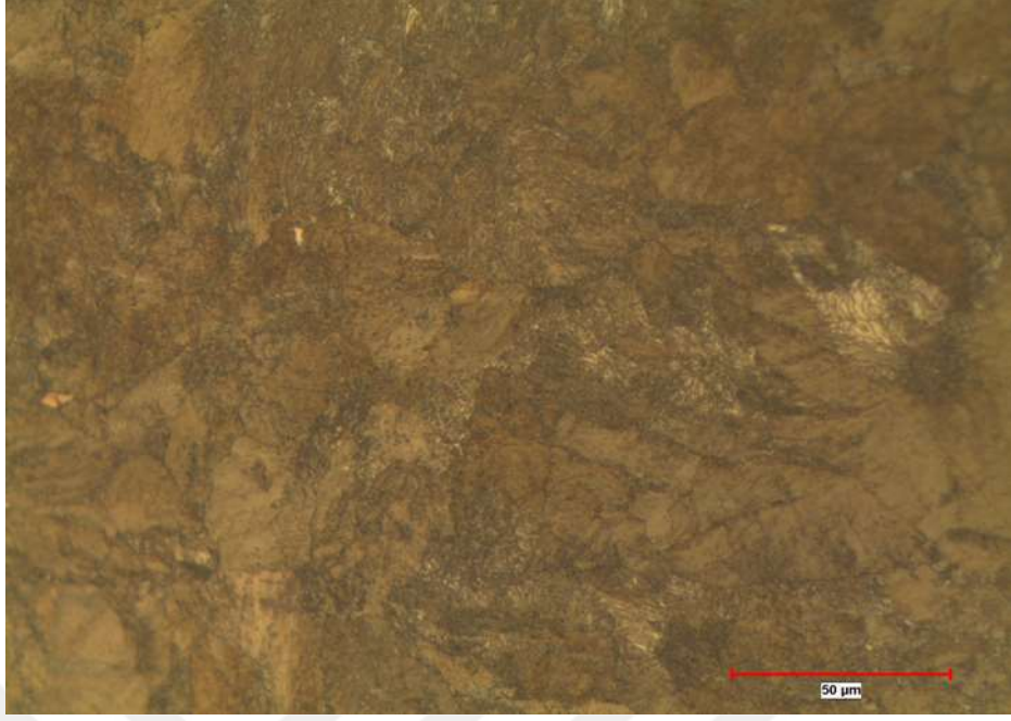
Şekil 4.8. R260 mikroyapı görüntüsü (50x).
