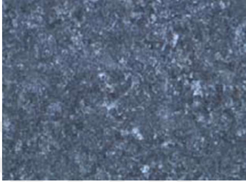
Şekil 4.6. R260 üst bölge mikro yapı görüntüsü (500x).
