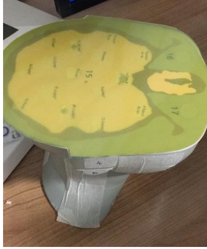
Resim 6: Fantomun belirlenmiş kesitine yerleştirilen EBT3 gafkromik film görüntüsü
