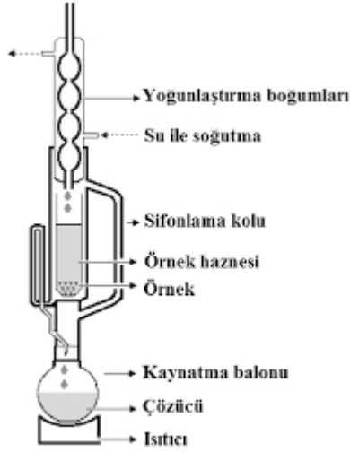
Şekil 3.7. Yağ analizinde kullanılan soksalet düzeneği
