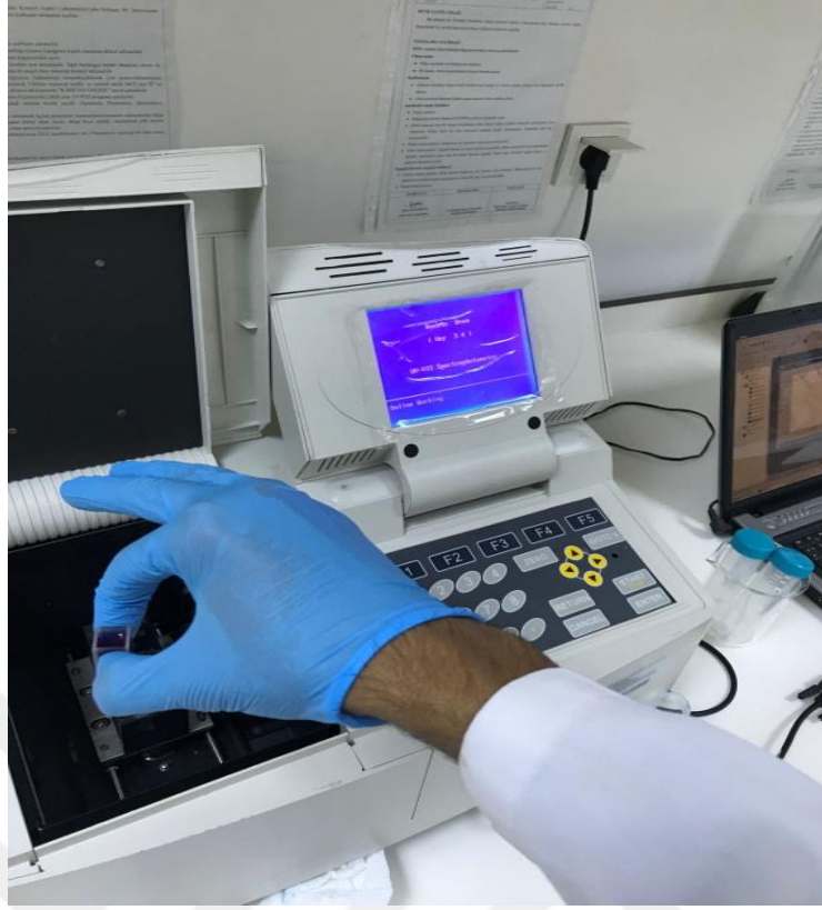
Şekil 3.12. Örneklerin UV-VIS spektrofotometrede absorban ölçümü (Orijinal)
