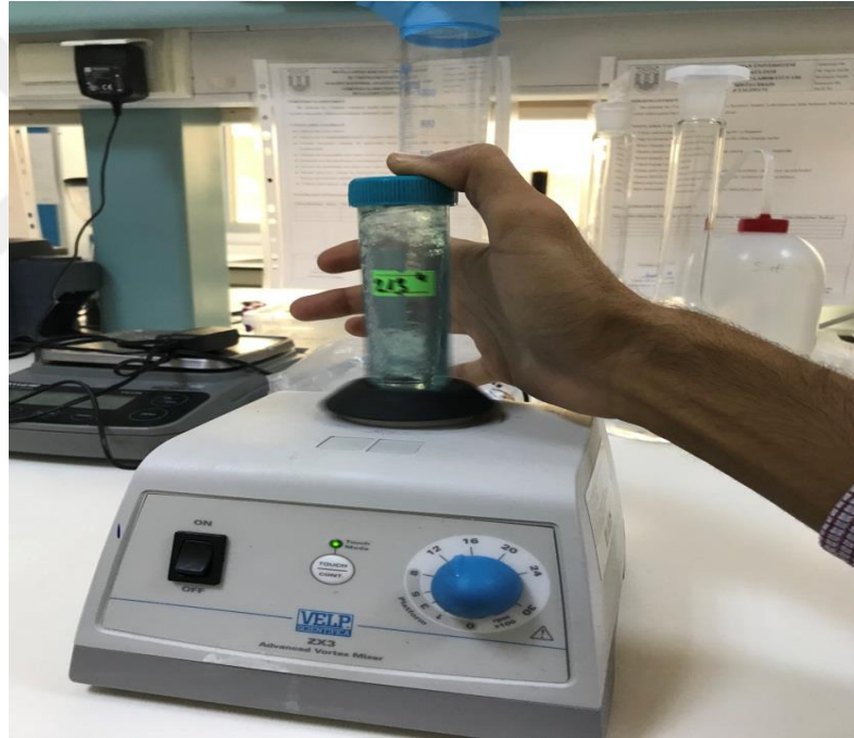
Şekil 3.6. Örneklerin vortekslenmesi (Orijinal)
