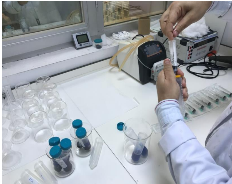
Şekil 3.10. Örneklerin filtrasyon (25mm 0.45 \mu\text{m} ) işlemi (Orijinal)
