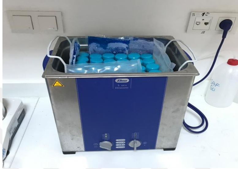
Şekil 3.7. Örneklerin ultrasonik banyo kullanılarak çözündürülmesi (Orijinal)
