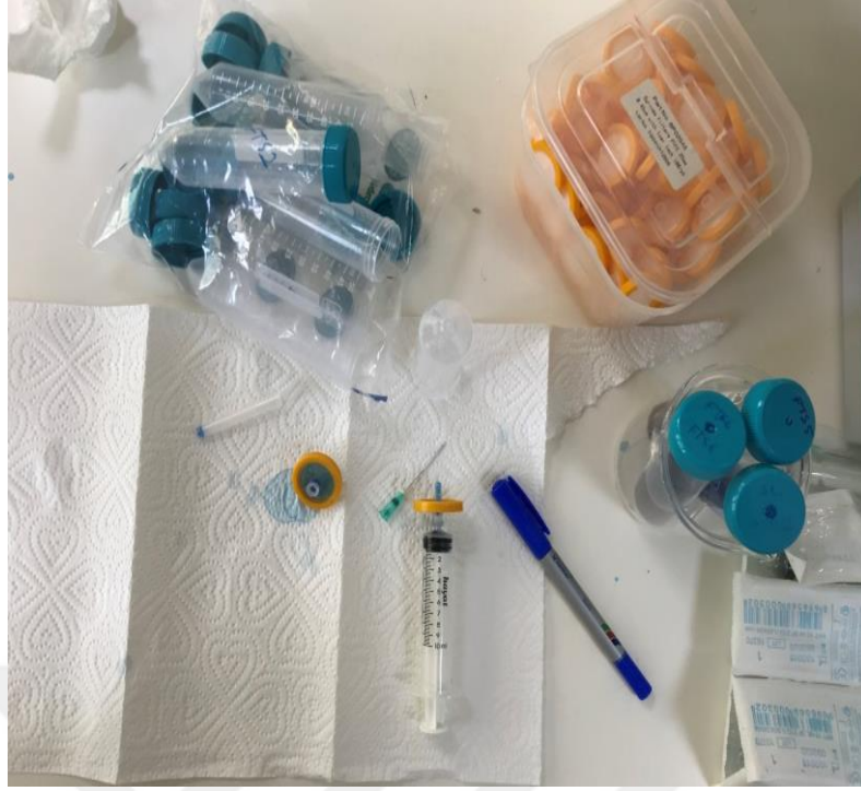
Şekil 3.11. Örneklerin filtrasyon (25mm 0.45 µm) işlemi (Orijinal)
