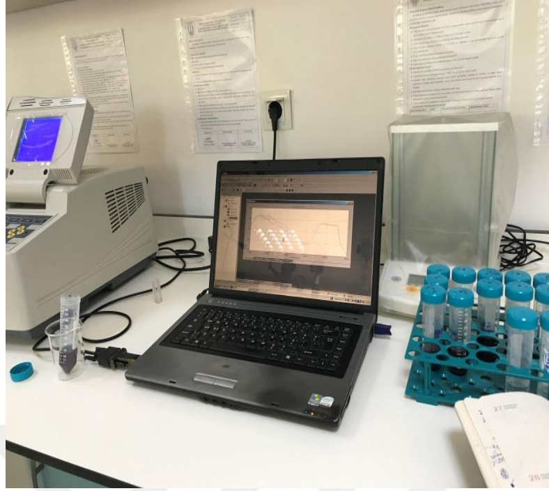
Şekil 3.13. Örneklerin UV-VIS spektrofotometrede absorbans ölçümü (Orijinal)
