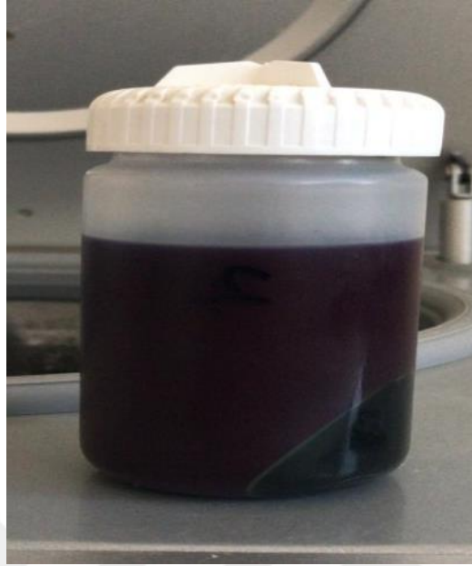
Şekil 3.17. Ultra soğutmalı santrifüj işlemi sonrası örnekte oluşan çökelti (Orijinal)
