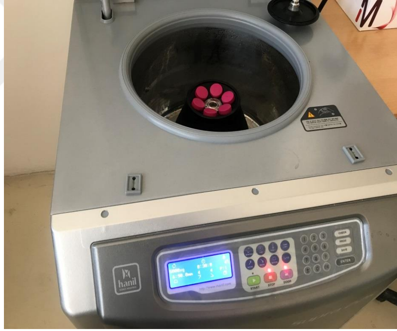
Şekil 3.15. Ultra santrifüj tüpleriyle örneklerin yüksek hızlı soğutmalı santrifüjde santrifüj işlemi (Orijinal)
