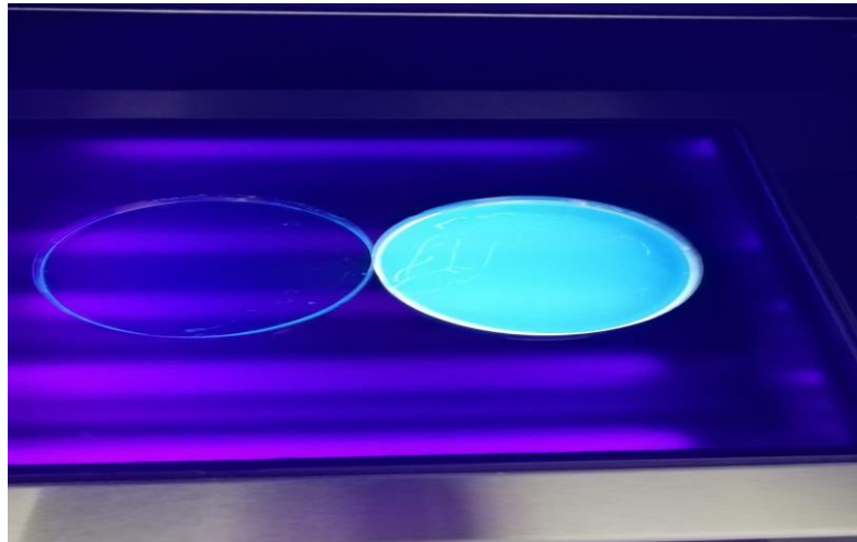
Şekil 4.8. Saf PVA ve CQD katkılı PVA filmlerin Uv ışığı altındaki görüntüsü
