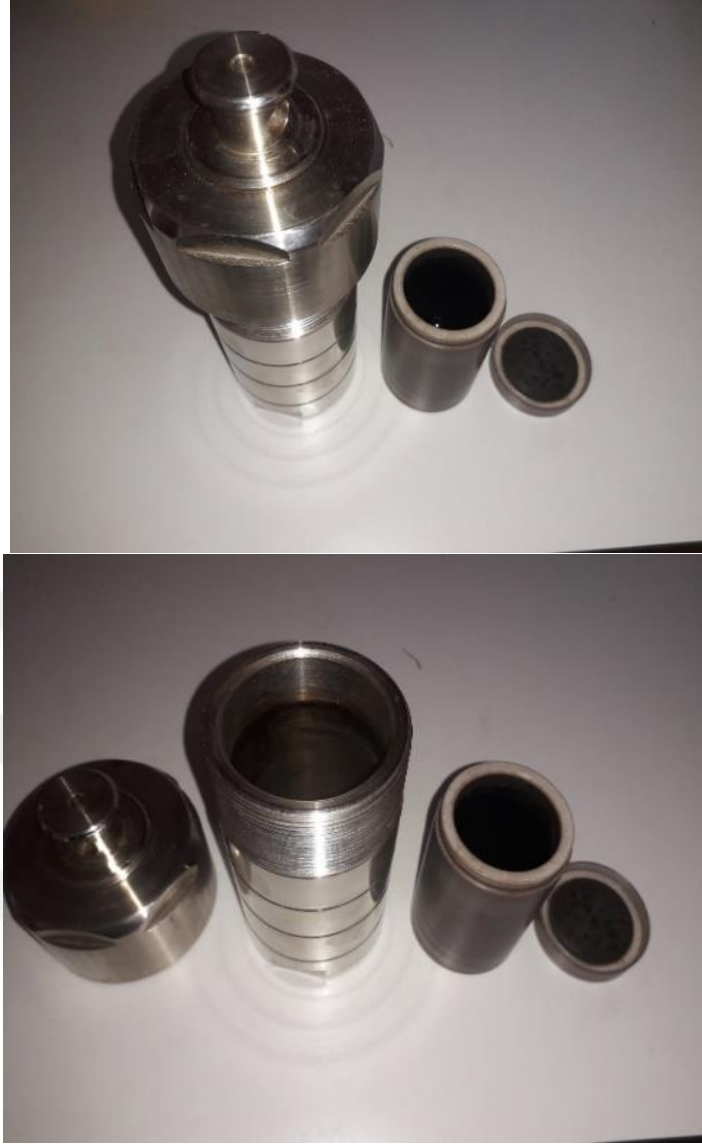
Şekil 3.10. Hidrotermal yöntem için kullanılan paslanmaz çelik otoklav ve teflon astar
