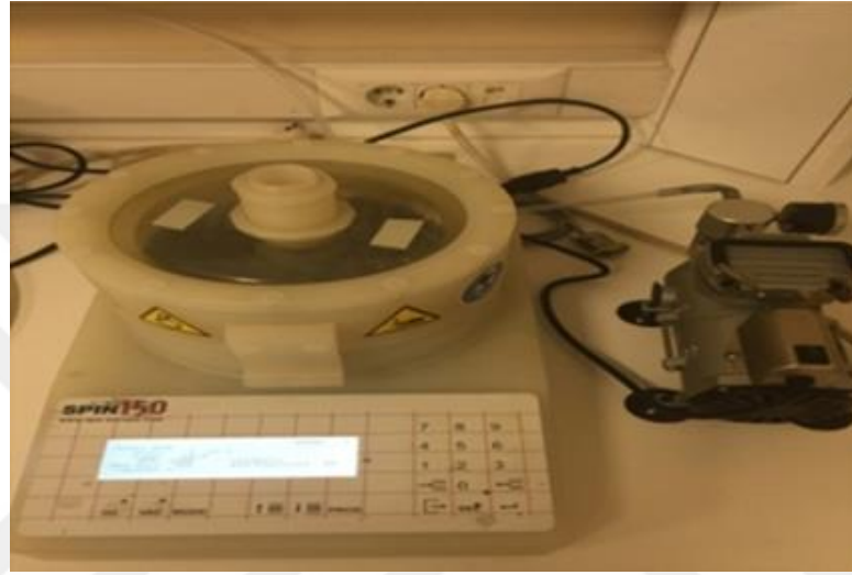
Şekil 3. 2 Perovskit tabakasının oluşturulmasında kullanılan döndürerek kaplama cihazı
