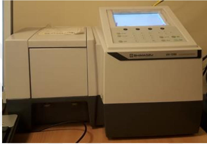
Şekil 3. 1 Soğurma spektrumlarının ölçülmesinde kullanılan UV-vis spektrofotometre
