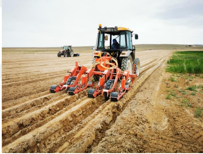
Şekil 3.1. Pnömatik hassas sebze ekim makinesi ve ekimde kullanılan baskı tekerleri
