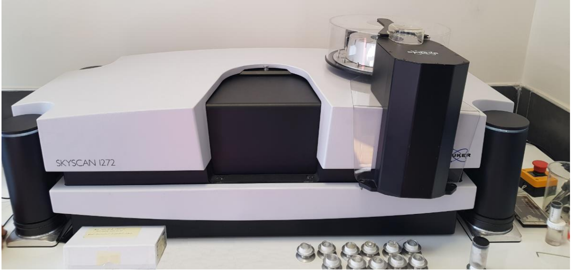
Şekil 3. 1. Bruker Skyscan 1272 Model Mikro-BT Cihazı
