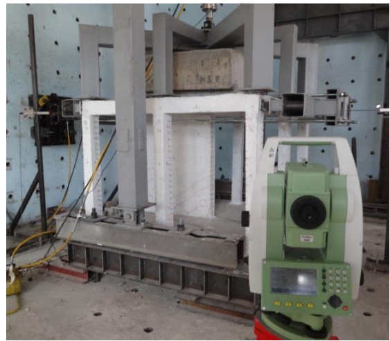
Şekil 3.43. Total Station ve Potansiyometrik Cetvel Deplasman Okumaları Karşılaştırılması
