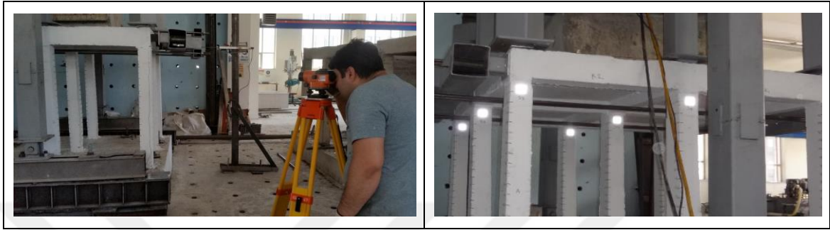
Şekil 2.51. Nivo Kullanımı ve Reflektörlü Kâğıt Yerleşim Planı
