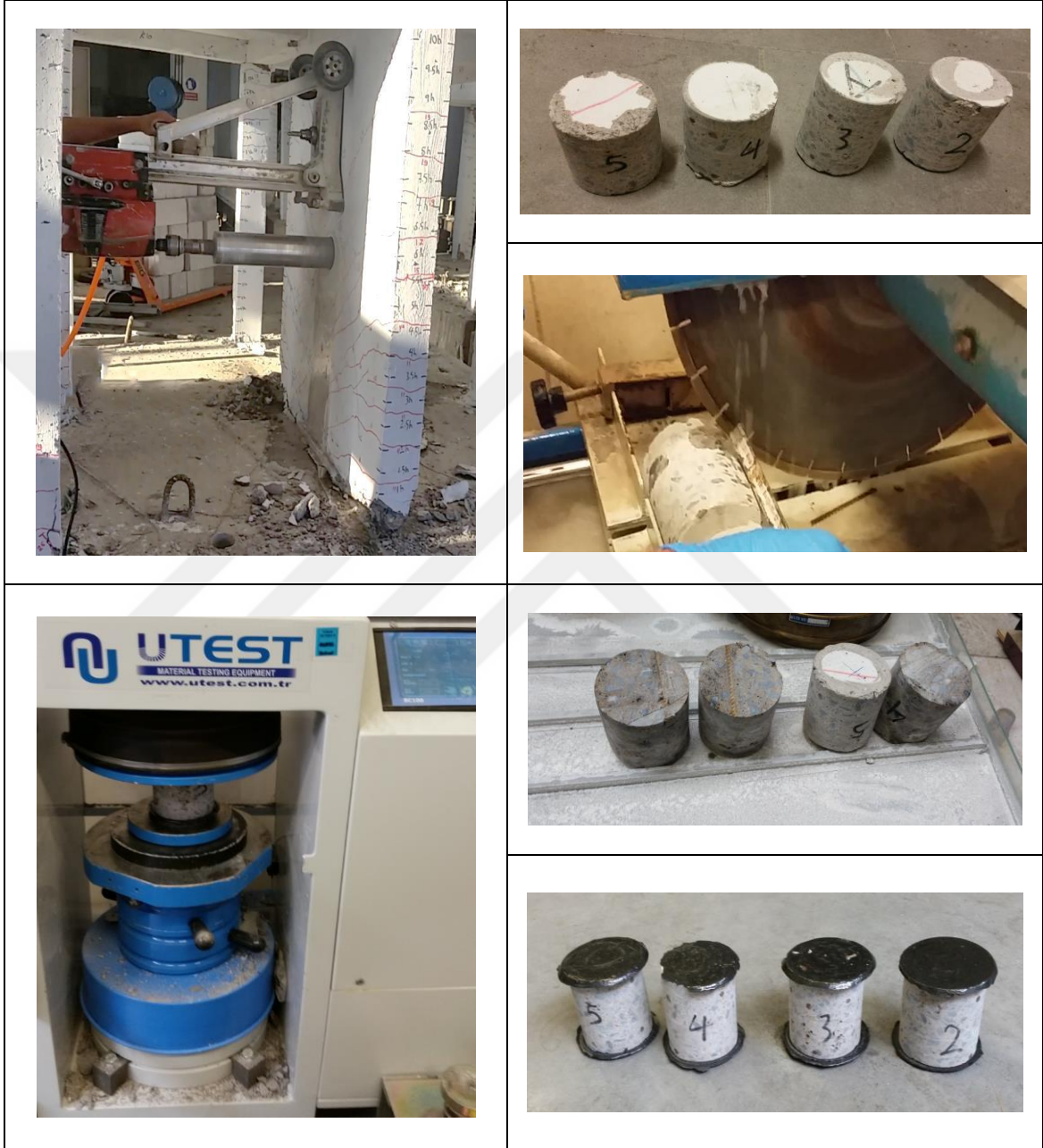
Şekil 2.70. Karot Numune Dayanım Deneyleri
