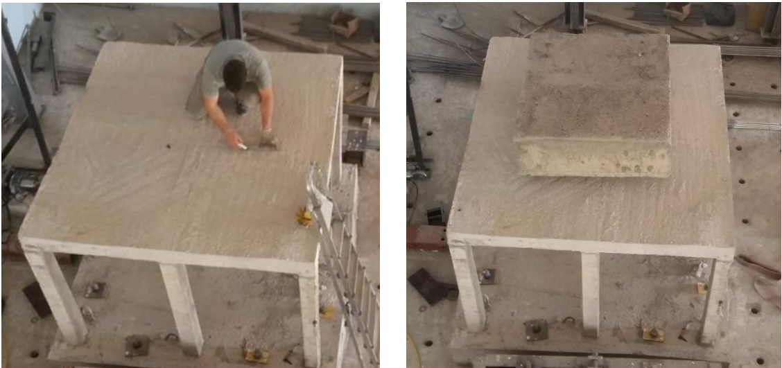
Şekil 2.74. Kütle Beton Yerinin Belirlenmesi ve Yerleştirilmesi
