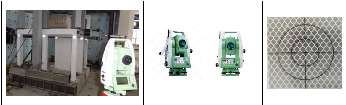
Şekil 2.50. Total Station cihazı ve Reflektörlü Kâğıt Detayı
