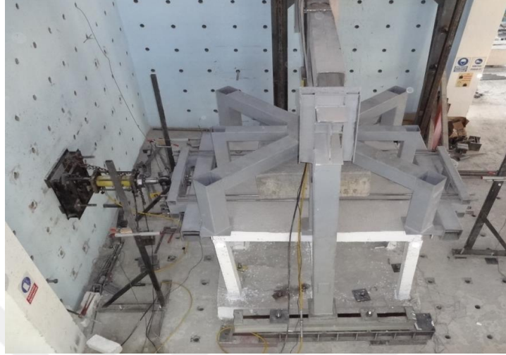
Şekil 2.79. Ölçüm ve Test Cihazlarının Montaj ve Bağlantılarının Yapılması
