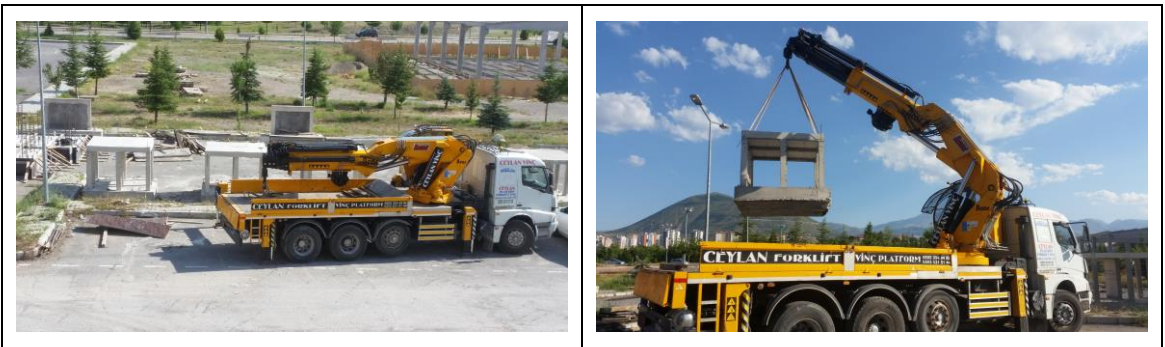
Şekil 2.31. Betonarme Taşıyıcı Sistem Numunelerinin Taşınması
