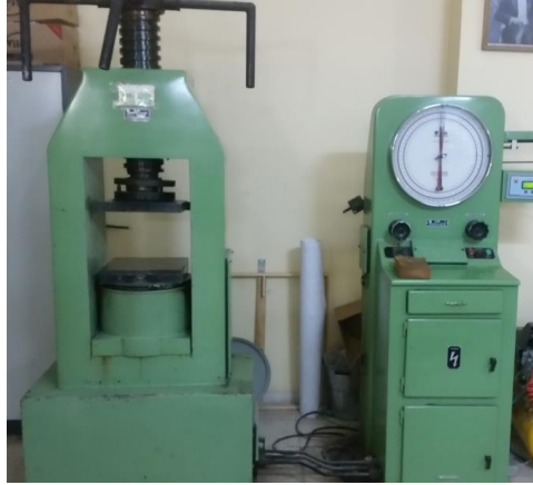
Şekil 2.61. Beton Basınç Dayanımı ve Çekmede Yarma Deneyi Cihazı
