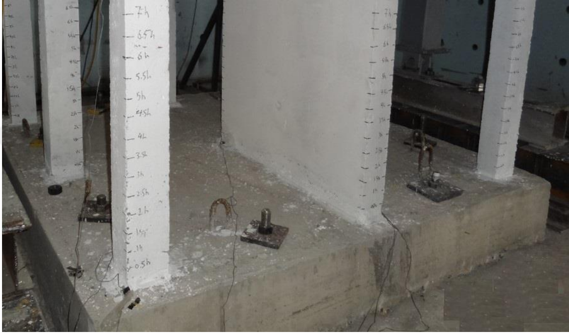
Şekil 2.73. Model Temelinin Ankraj ile Laboratuvar Tabanına Bağlanması
