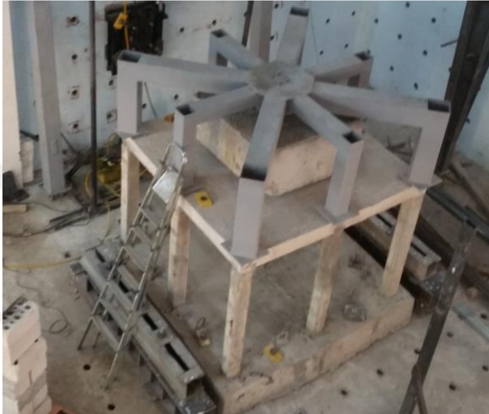
Şekil 2.75. Örümcek Şekilli Aksenal Yük Düzeneginin Yerleştirilmesi
