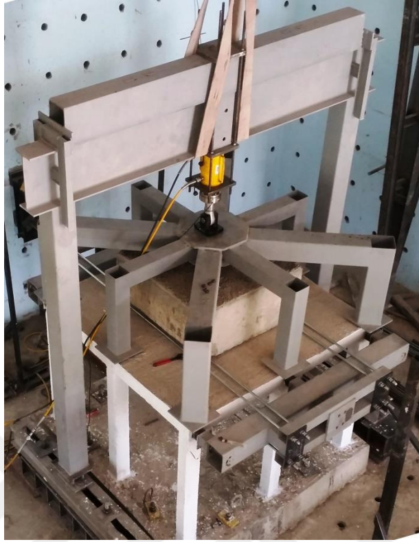
Şekil 2.78. Eksenel Yükleme Çerçevesinin Yerleştirilmesi
