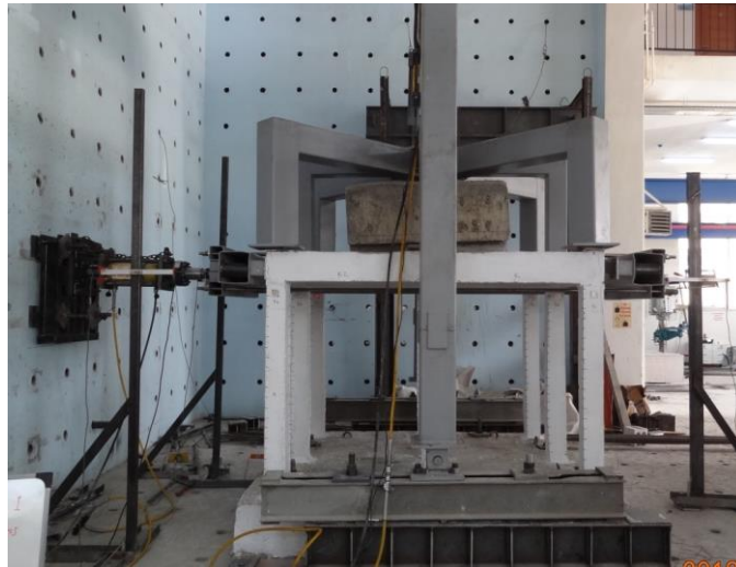
Şekil 2.80. Ölçüm Cihazlarının ve Strain Gauge Köprü Kablolarının Bağlanması
