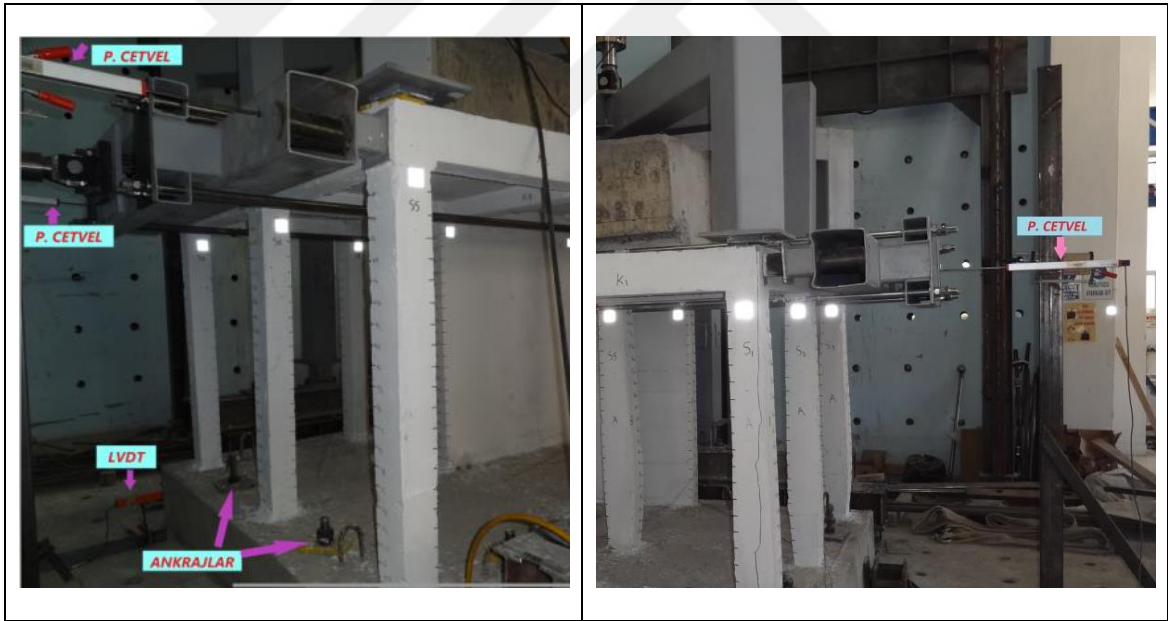
Şekil 2.53. Potansiyometrik Cetvel, LVDT ve Ankraj Yerleşimi
