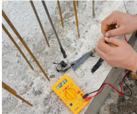
Şekil 2.57. Strain Gaugelerin Direnç Kontrolü
