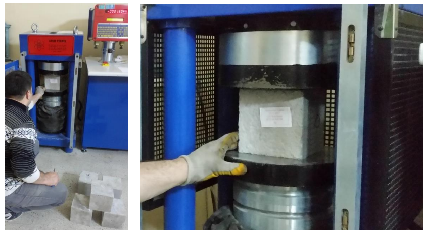
Şekil 2.60. Küp Numunelerin Basınç Dayanımını Ölçen Pres Cihazı
