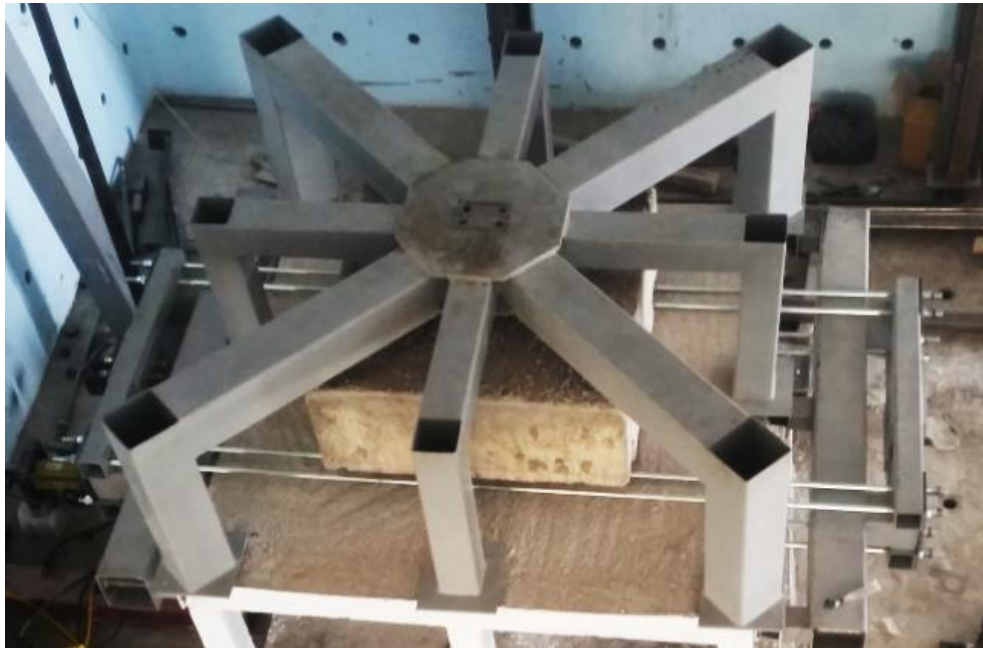
Şekil 2.77. Yatay Yükleme Düzeneğinin Yerleştirilmesi
