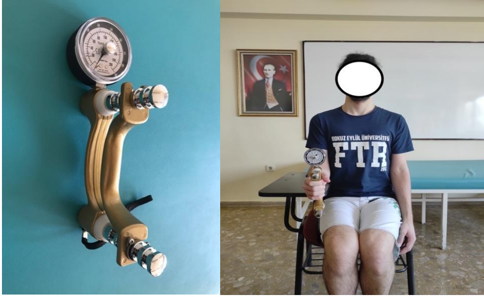
Şekil 11. Kavrama Kuvveti Ölçümü
