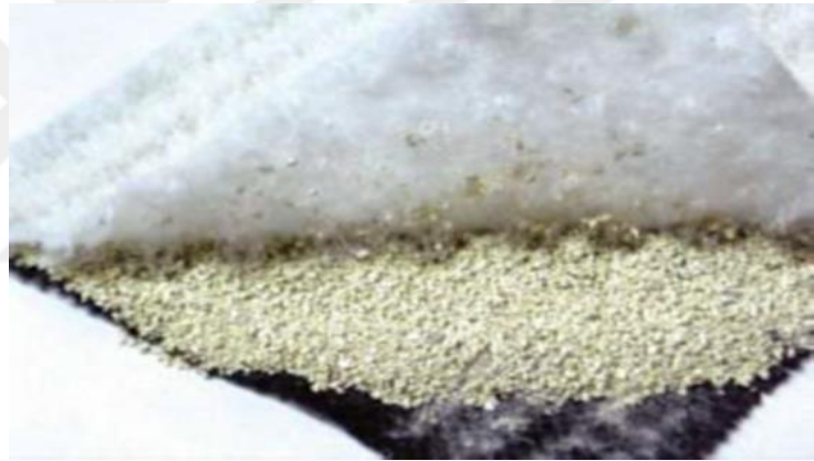
Şekil 1.5. Geosenteik kil kaplama örneği [21]
