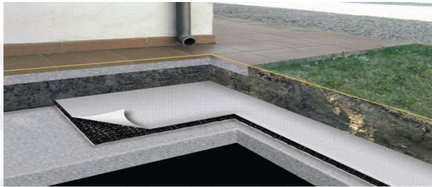
Şekil 1.48. Kaldırım döşemesi altında geotekstilin koruma amacıyla kullanılması [72]
