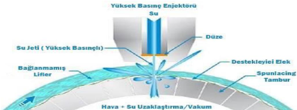
Şekil 1.25. Su jetiyle tülbent bağlama sistemi [56]
