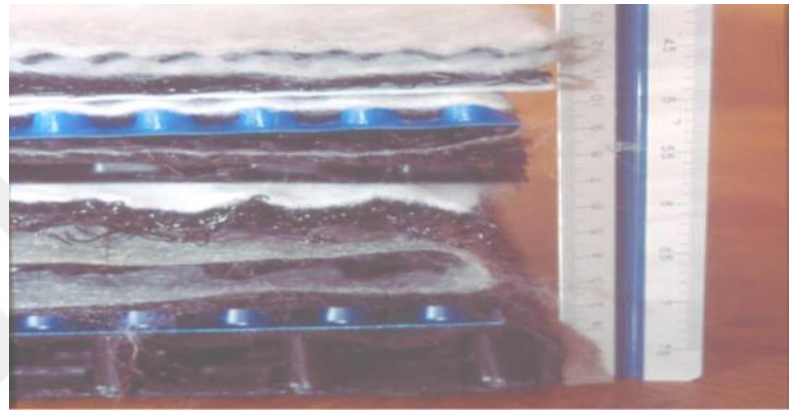
Şekil 1.6. Geokompozit dren örneği [18]
