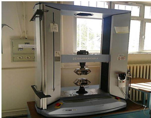
Şekil 2.3. Shimadzu marka çekme cihazı
