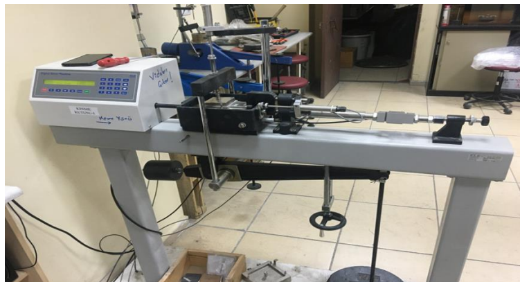
Şekil 2.4. Çalışmalarda kullanılan kesme kutusu deney düzeneğinin görünümü
