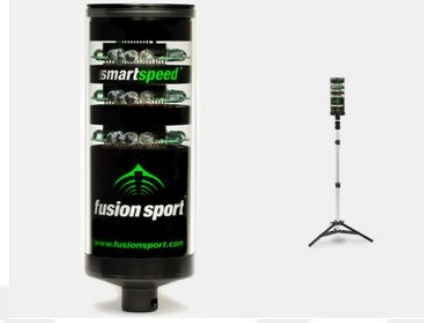
Şekil 3.3. Çift Kapılı Fotosel Sistemi
