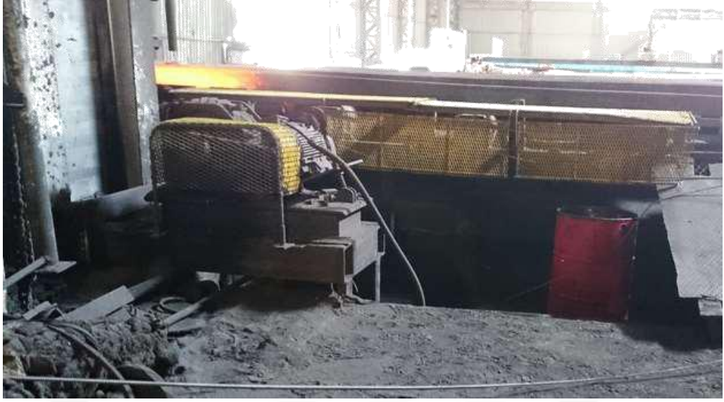
Şekil 4.14. Kayış kasnak sisteminin koruyucu muhafazası
