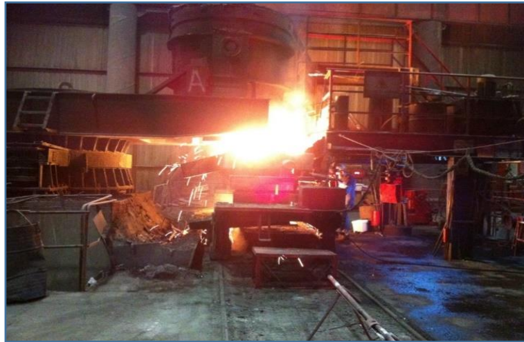
Şekil 4.6. Sıvı çeliğin deşarj işlemi
