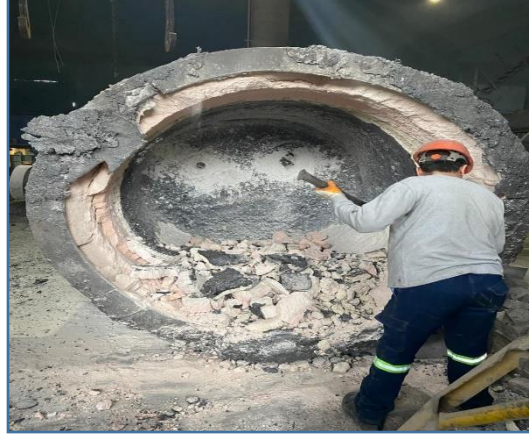
Şekil 2.6. Sıvı Çeliğin İçerisine Konulduğu Potaların Isıtılması Ve Tamiratu
