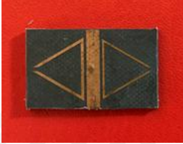
Şekil 4.2 Rogers RT/Duroid 5880 alttaş kullanılarak üretim yapılmış mikroşerit yapı
